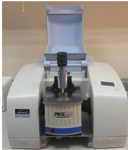
Şekil 4.8. PerkinElmer Spektrum 400 FT-IR Spektrofotometre
