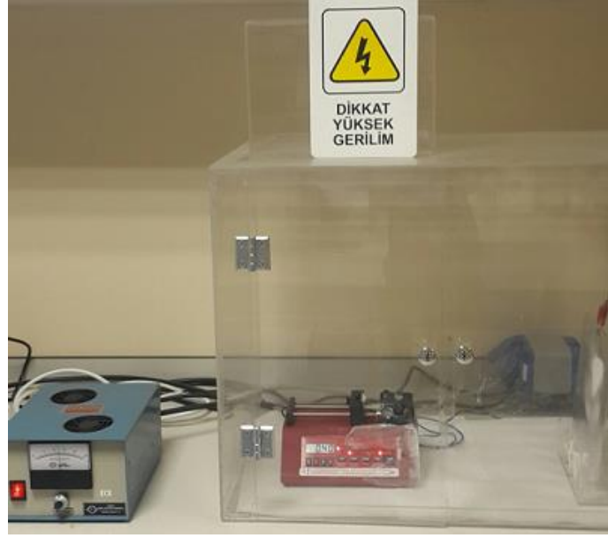
Şekil 4.3. Çalışmada kullanılan elektroçekim düzeneği
