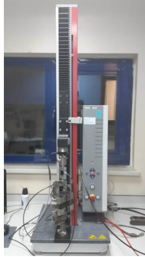
Şekil 4.5. Zwick-Roell BT-1 Üniversal çekme dayanımı test cihazı
