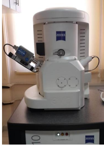
Şekil 4.4. Carl Zeiss Evo LS10 taramalı elektron mikroskobu
