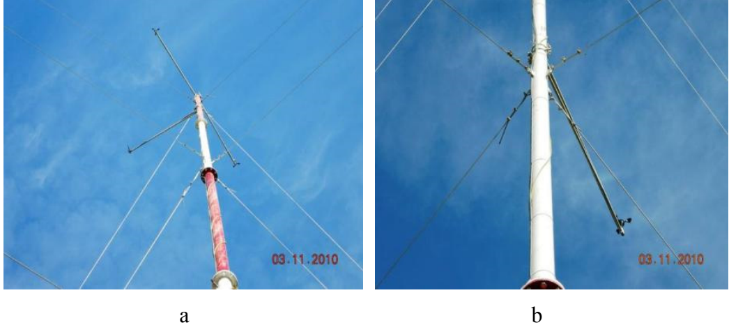
Şekil 3.4. 30.m deki (a) ve 10.m deki (b) sensörler ve emniyet halatlarının görünümü.
