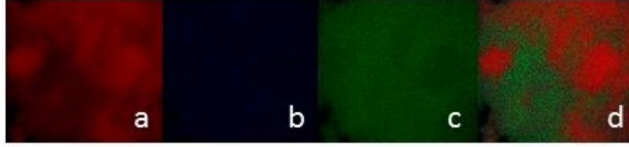
Şekil 4.17: a.) alüminyum b.) bakır c.) nikel d.) indirgenmiş Ni-Cu/Al 2 O 3 _95-5 katalizörü EDS harita görüntüleri.
