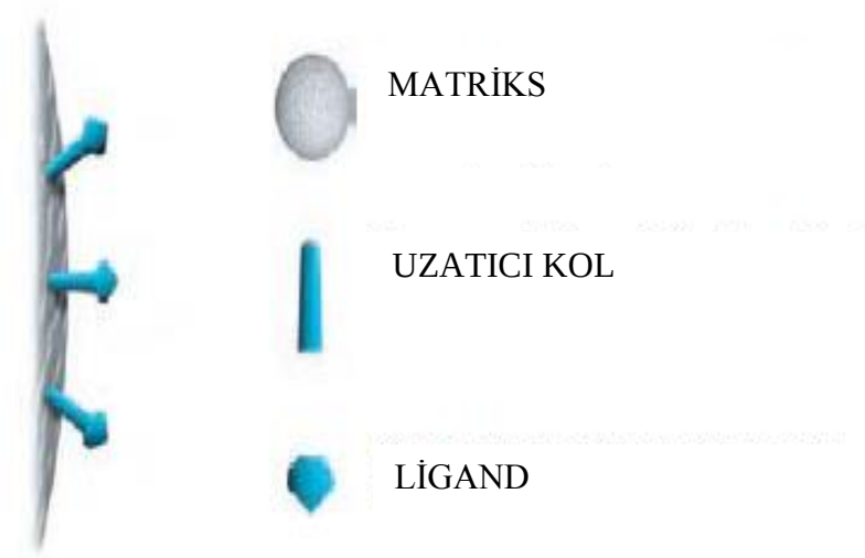
Şekil 2.16. Afinite kromatografisinin temel bileşenleri [59]
