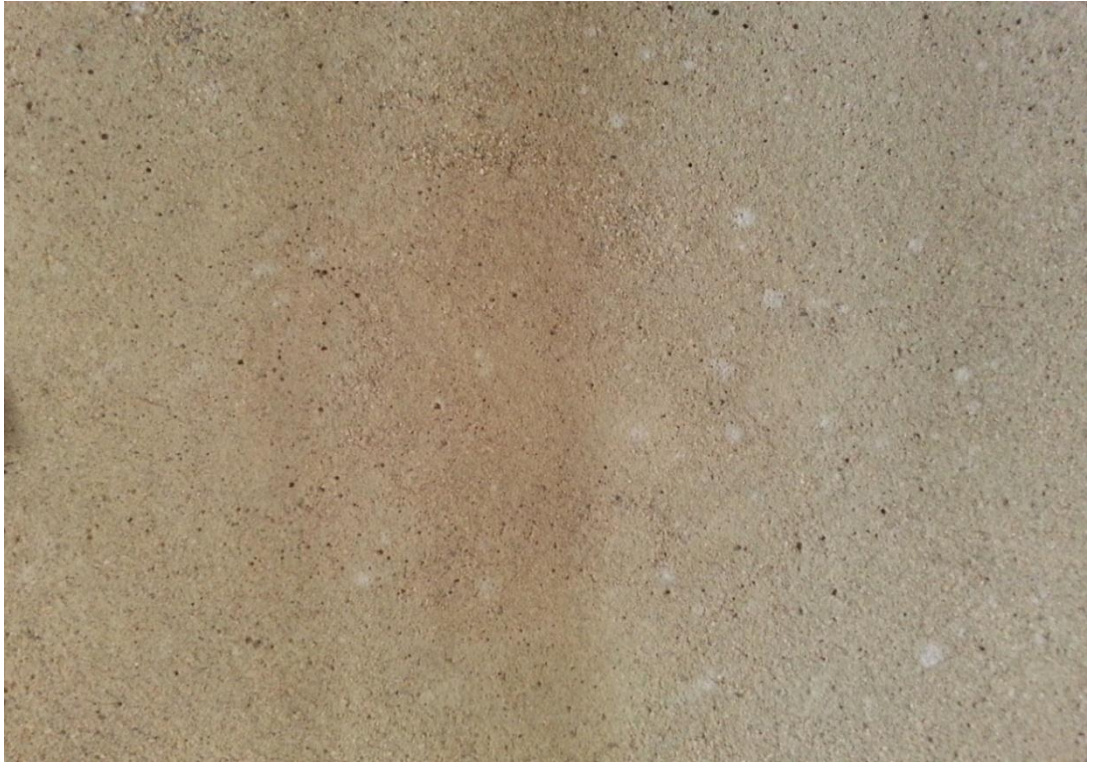
Şekil 6.3: Kil uçucu kül karışımı 56.gün (%3).
