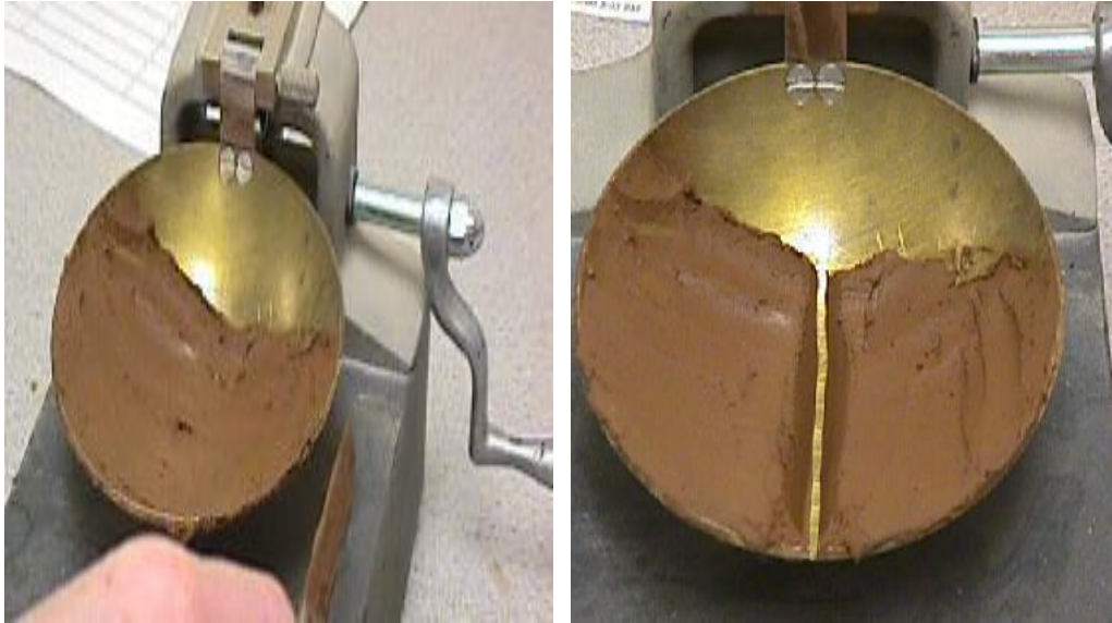
Şekil 5.5: Cassagrande deney aleti ile likit limit değerinin tayin edilmesi.
