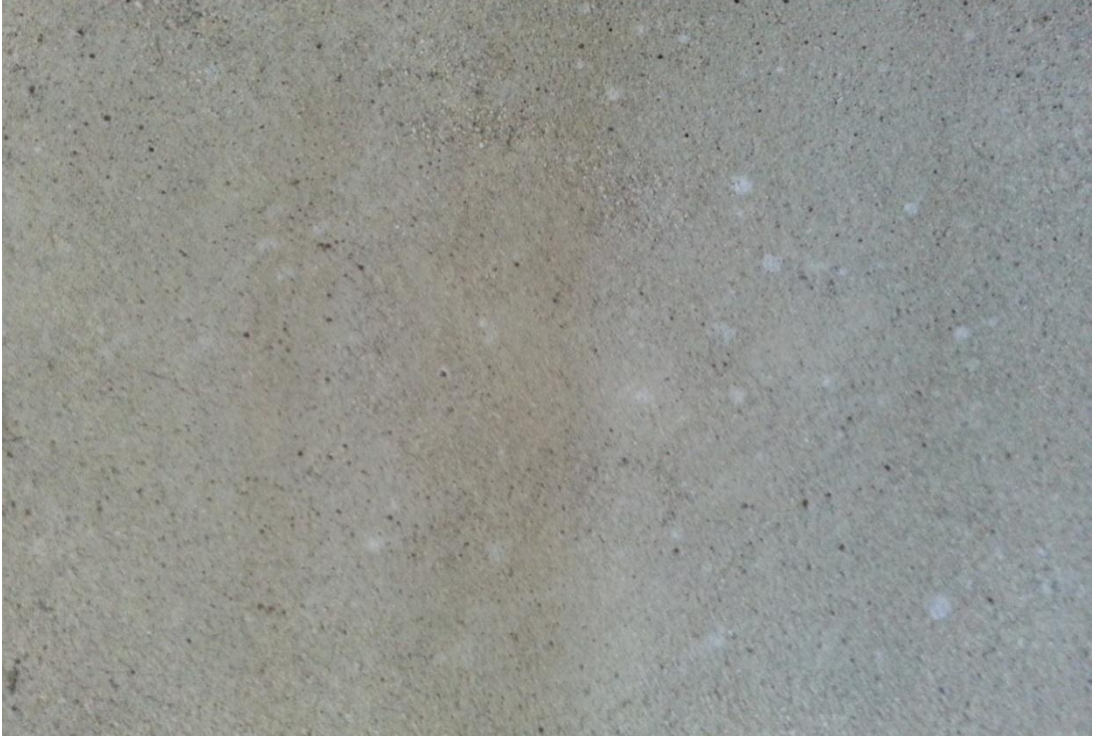
Şekil 6.2: Kil uçucu kül karışımı 28.gün (%3).
