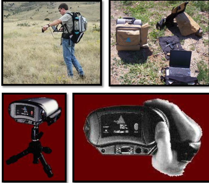
Şekil 1.39. El Tipi Spektrometre ve Arazi Ölçümü (Url-8).
