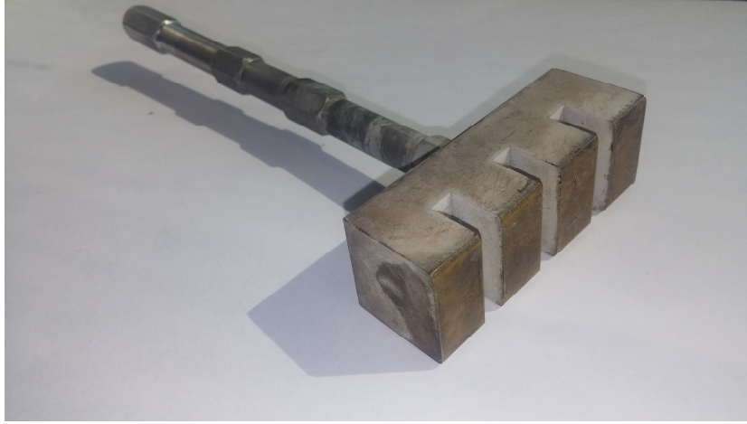
Resim 1: Yanık modelinde temas yanığı oluşturmak için kullanılan metal plak.
