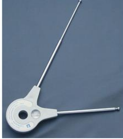
Resim 3: Çalışmada kullanılan manuel goniometre.
