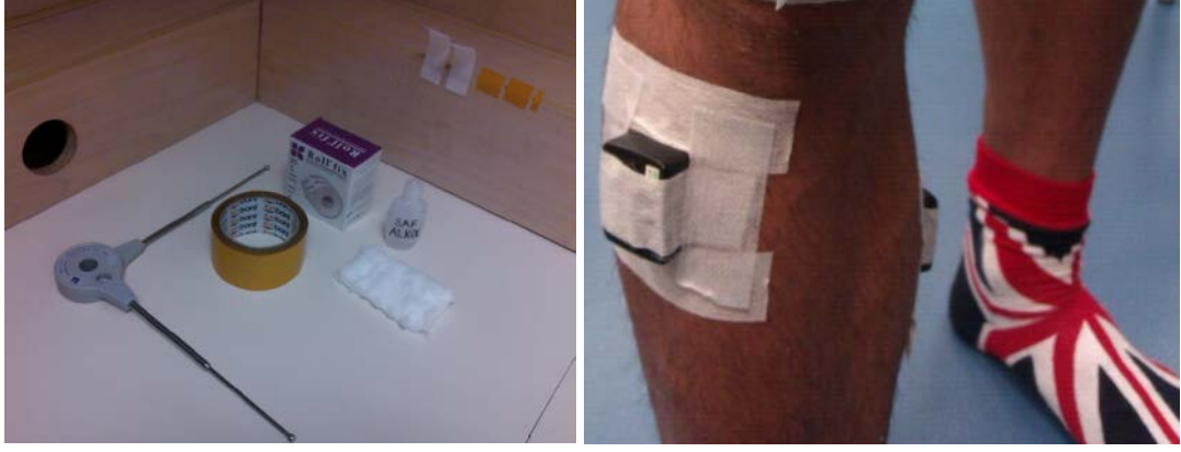
Resim 9: sEMG elektrotları deriye titreşim sırasında yerinden ayrılmasını önlemek amacıyla sağlam bir şekilde yapıştırıldı.
