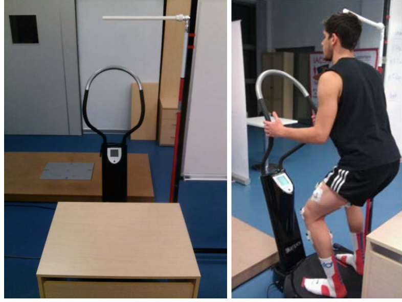
Resim 7: Diz eklem açısının 120^\circ olduğu pozisyonda katılımcının başının üzerine hafifçe temas edecek sabit bir plastik çubuk, yere paralel olarak konumlandırıldı ve katılımcı bu teması hafifçe hissedecek şekilde pozisyonunu korudu.
