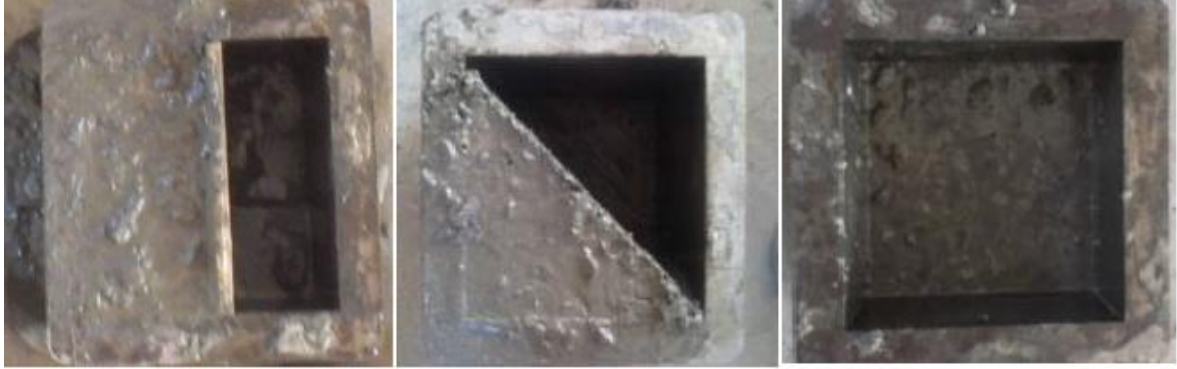
Şekil 2.6. Çalışmada gösterilen betonun yerleştirme şekli
