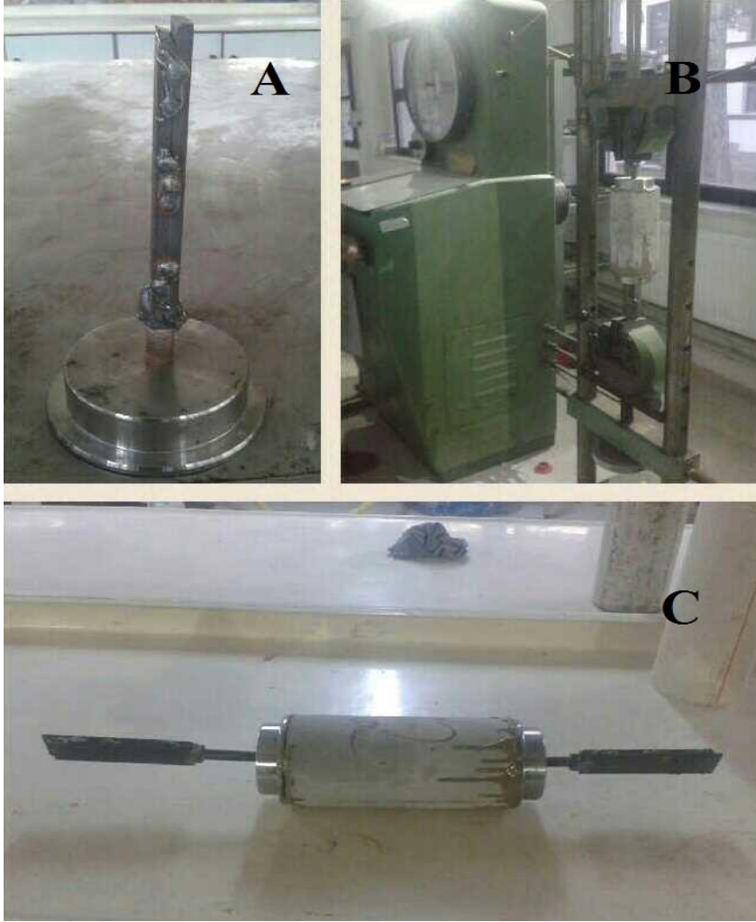
Şekil 3.6. Çekme dayanımı deneyinde kullanılan A) doğrudan çekme deney makinası, B) beton numunelerin yüzeylerine yapıştırılan çelik başlık, C) çelik başlık yapıştırılarak doğrudan çekme deneyine hazır hale getirilmiş bir beton numunesi
