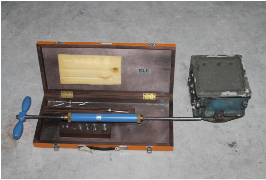
Şekil 3.4. Standart yük uygulama cihazı
