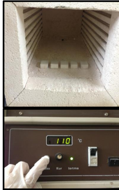
Resim 45: Örnekler 2 saat fırında kurutuldu.
