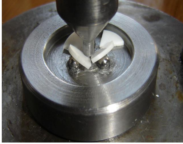
Resim 19: Biaksiyel eğme testinden 3 top üzerinde piston (145)
