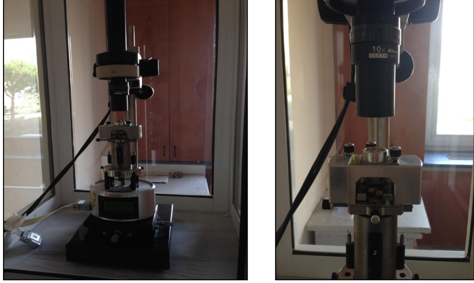
Resim 63, 64: Atomik Kuvvet Mikroskobu
