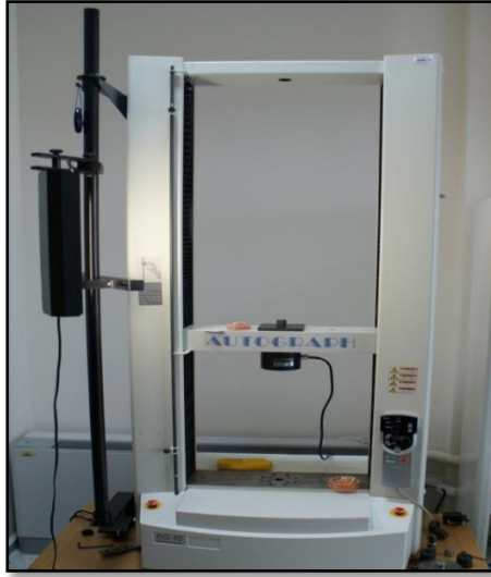
Resim 58: Universal Test Cihazı
