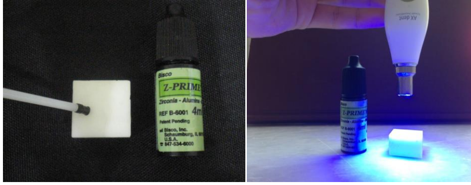
Resim 37, 38: Z-Prime Plus'ın uygulanması ve polimerizasyonu
