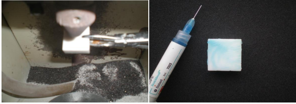
Resim 33: Blokların 10 mm uzaktan 15 sn süre ile 50 \mu\text{m} \text{Al}_2\text{O}_3 ile kumlanması
