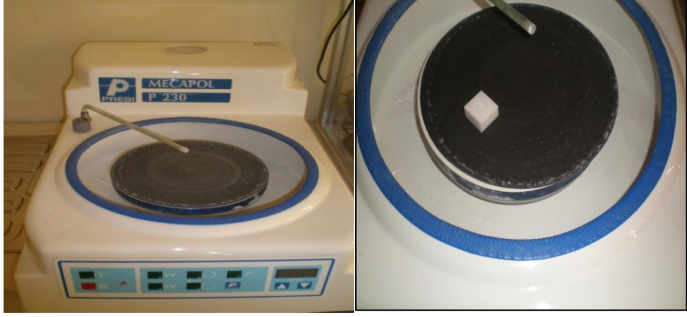
Resim 31, 32: Zirkon blokların zımpara cihazında zımparalanması
