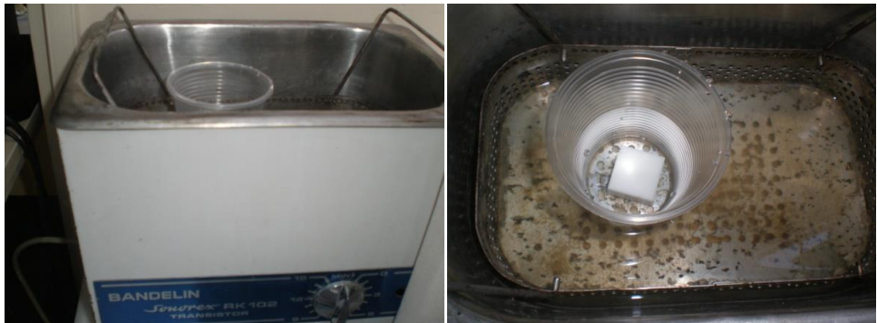
Resim 35, 36: Ultrasonik banyoda yıkama
