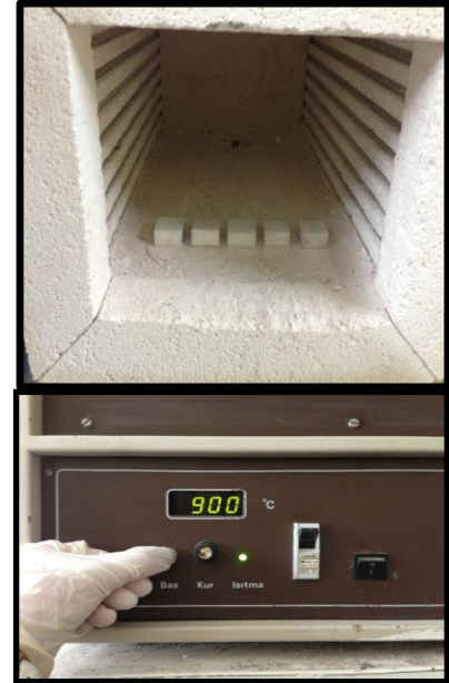
Resim 46: Daha sonra 900°C' de 1 saat ısı ile muamele edildi.
