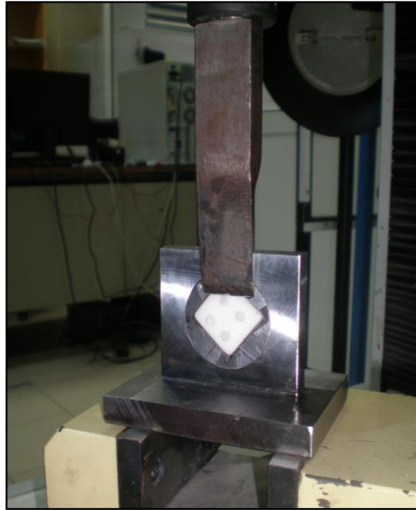
Resim 60: Makaslama testinin uygulanması
