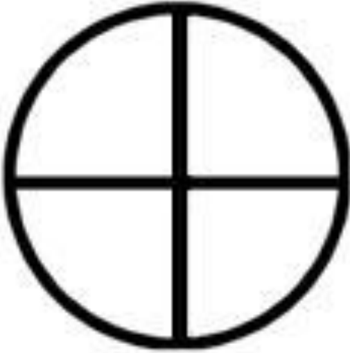
Şekil 3.1. Omik kontak oluşturmak için kullanılan maske
