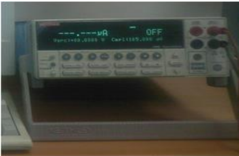
Resim 2.3. Keithley 2400 akım-gerilim kaynağı
