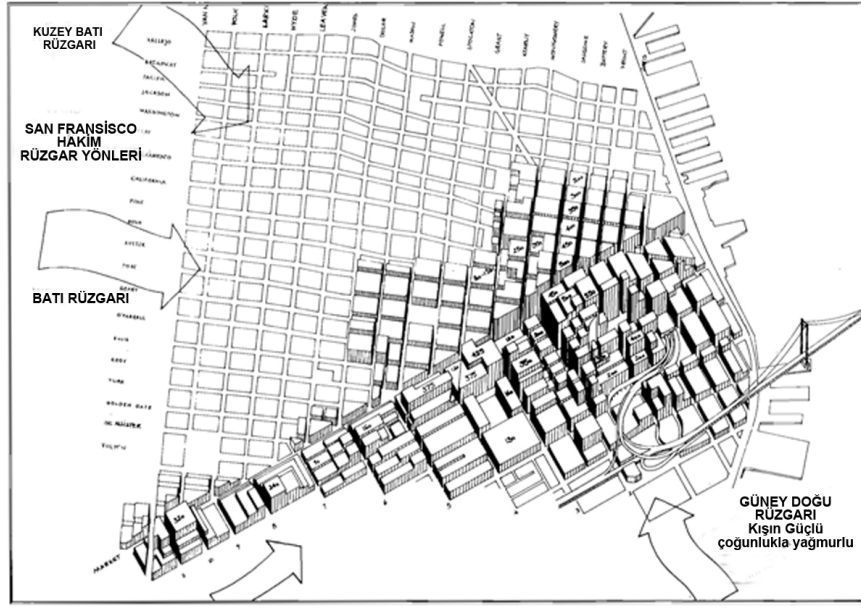
Şekil 4.15 : San Francisco İçin Rüzgarın Olumsuz Etkilerini Azaltacak Öneri Kent Formu ( Bosselmann ve diğ. ,1984, s:138).
