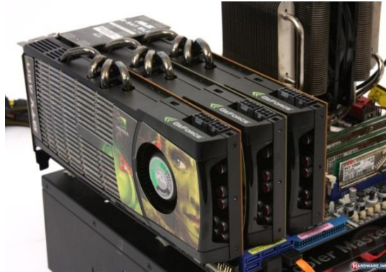
Şekil 8.13: Aynı ana makine üzerinde yer alan farklı PCI veri yollarına takılmış üç NVIDIA GeForce GTX 480 donanımı gösterimi.
