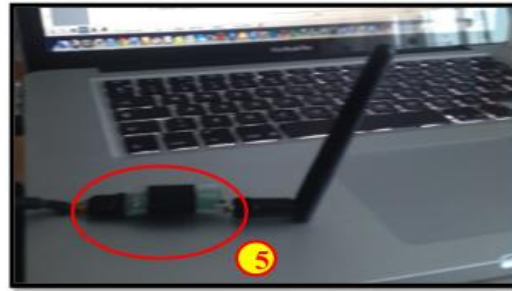
Şekil 9.18: Xbee alıcısı ile donatılmış kontrol istasyonu gösterimi.
