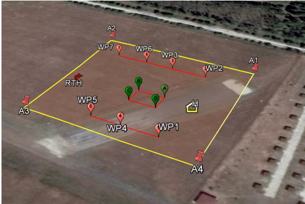
Şekil 9.26: Tek platform deney uçuşunun icra edileceği engel içeren alan gösterimi.
