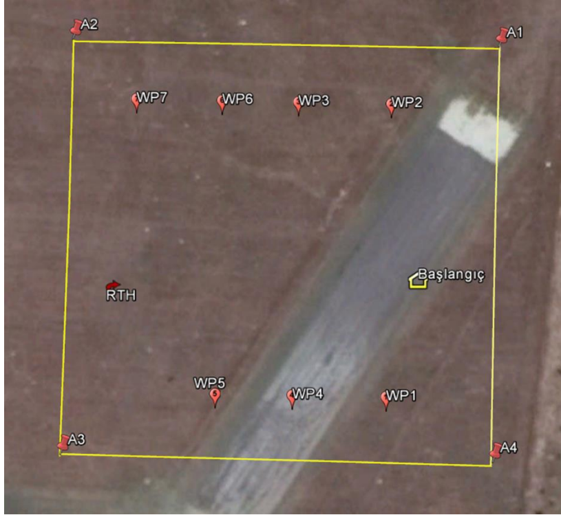
Şekil 9.22: Tek platform deney uçuşu için belirlenen engelsiz alandaki yol noktaları.
