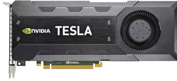
Şekil 2.23: NVIDIA Tesla K20c paralel hesaplama donanımı [60].
