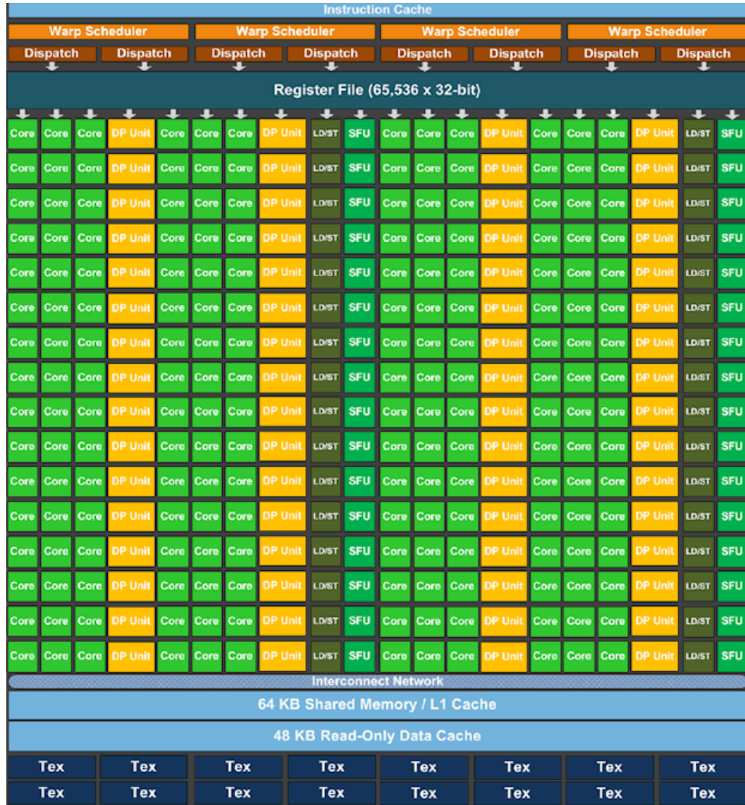
Şekil 2.16: NVIDIA Kepler GK110 GPU Mimarisi (SMX) [55].
