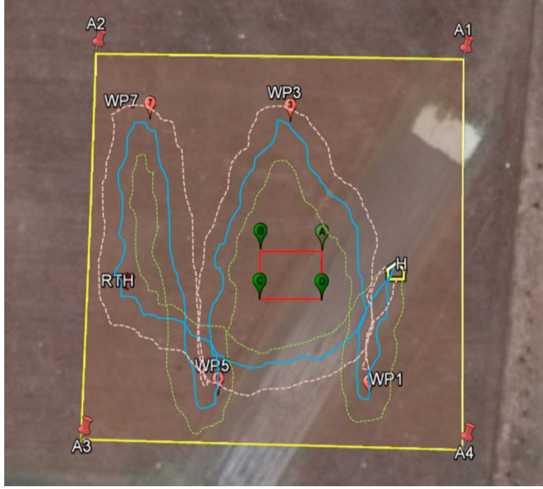
Şekil 9.38: Engel içeren alan dahilinde icra edilen formasyon uçuşu sonucunda platformların izlediği rotaların gösterimi.
