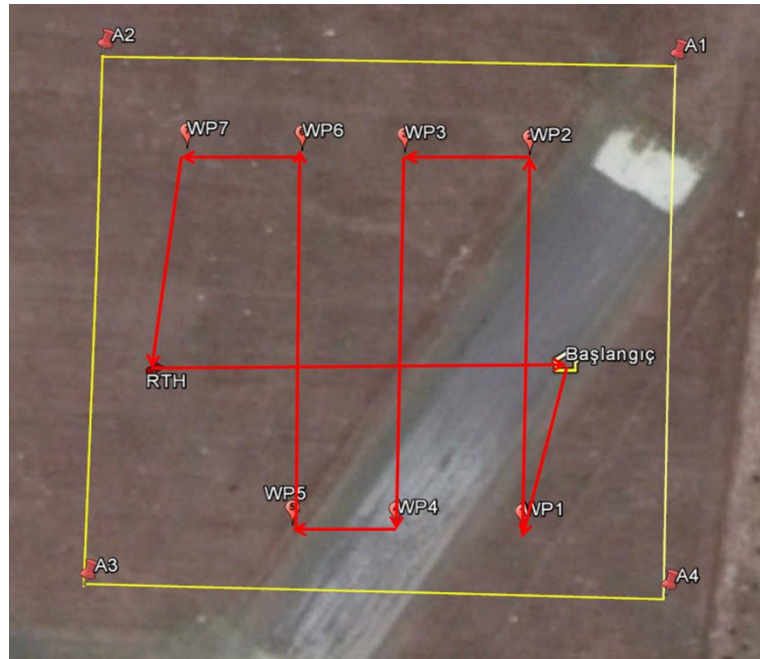
Şekil 9.23: Tek platform deney uçuşunun icra edilmesinde platformun izlemesi beklenen rota gösterimi.
