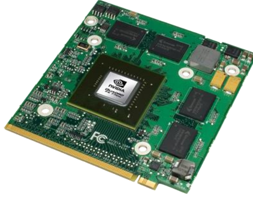
Şekil 2.21: NVIDIA Quadro 1000M grafik donanımı [58].
