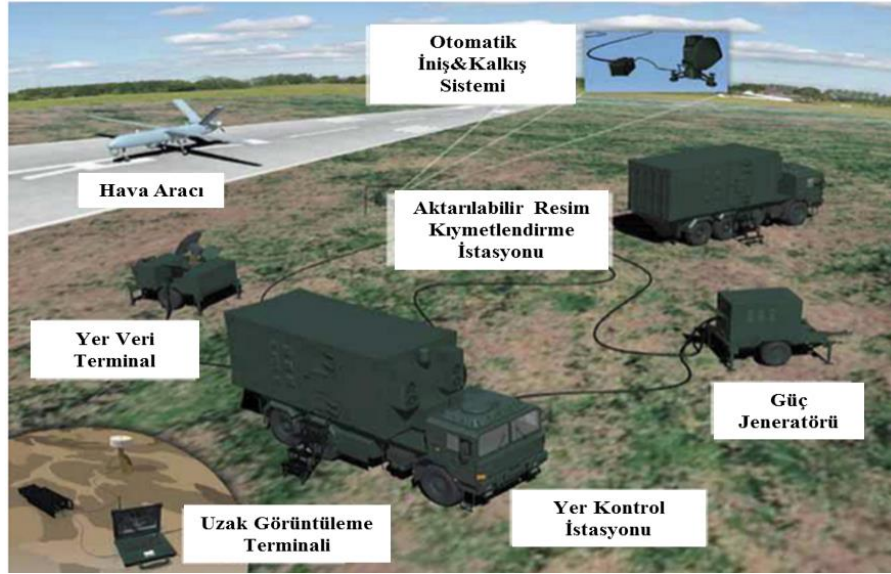
Şekil 2.2: Askeri amaçlı taktik sınıfı İHA sisteminin temel bileşenleri [19].
