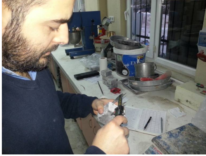
Şekil 3.34. Kesilen parke taşı numunelerinin ölçülmesi
