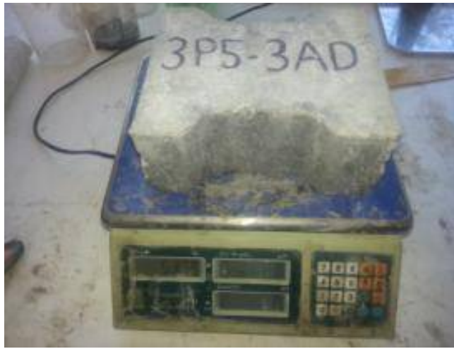
Şekil 3.21. P5 Numunesinin etüv sonrası tartımı
