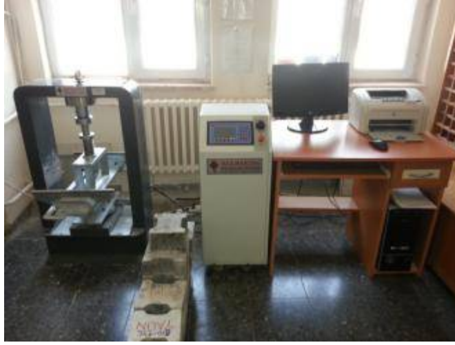
Şekil 3.27. Yarmada çekme deney aleti
