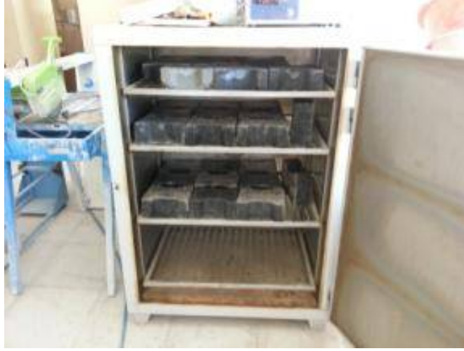
Şekil 3.19. Parke taşı numunelerinin etüve yerleştirilmesi
