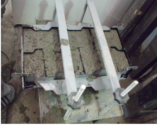
Şekil 3.11. Kalıpların sarsma tablasına alınması
