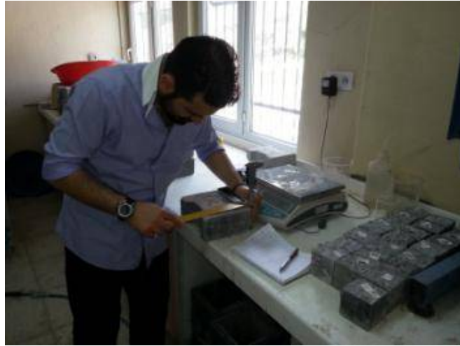
Şekil 3.24. Numunelerin çalışma boyutunun ölçülmesi
