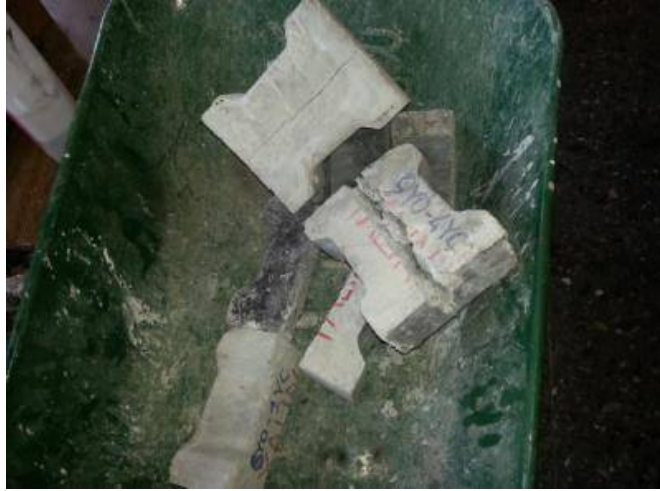
Şekil 3.31. Yarma çekme deneyi sonrası parke taşı numunelerinin görünümü
