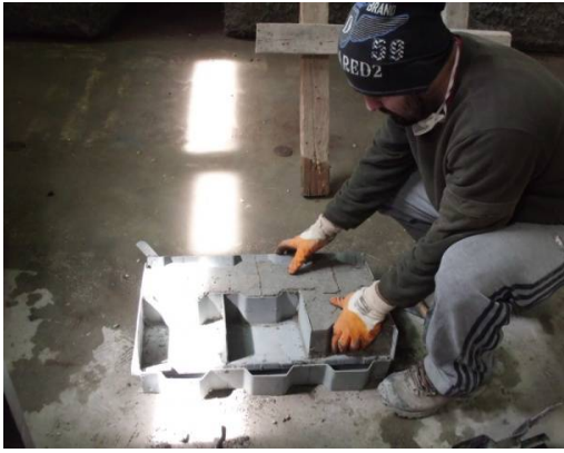
Şekil 3.12. Numunelerin kalıptan çıkarılması
