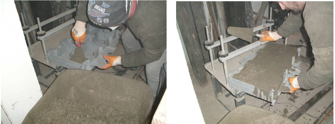
Şekil 3.10. Geri seken malzemenin kalıplara doldurulması
