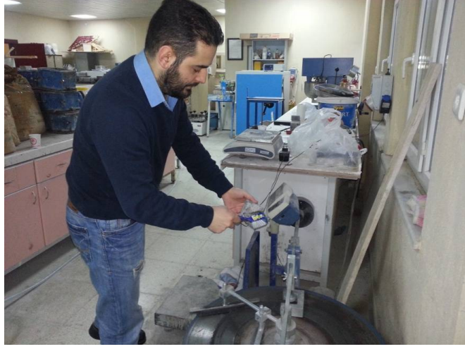
Şekil 3.36. Numune yüzeylerinin temizlenmesi
