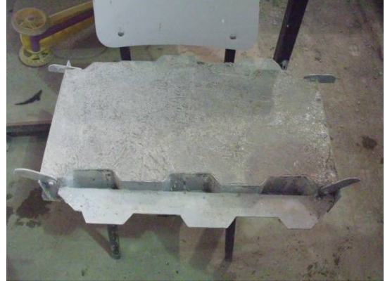
Şekil 3.11. Kalıpların sarsma tablasına alınması
