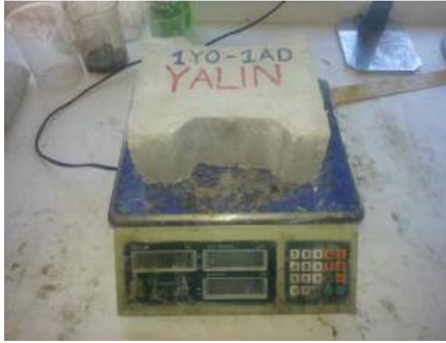
Şekil 3.20. Y0 numunesinin etüv sonrası tartımı
