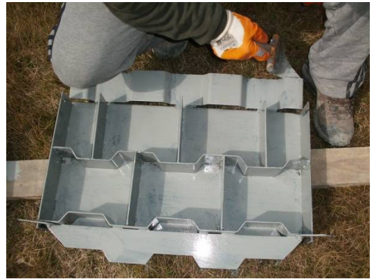
Şekil 3.7. Parke taşı kalıplarına astar çekilmesi
