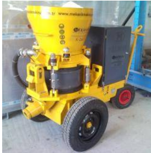
Şekil 3.3. Kuru karışım püskürtme beton makinesi (TÜBİTAK 111M335, 2013)
