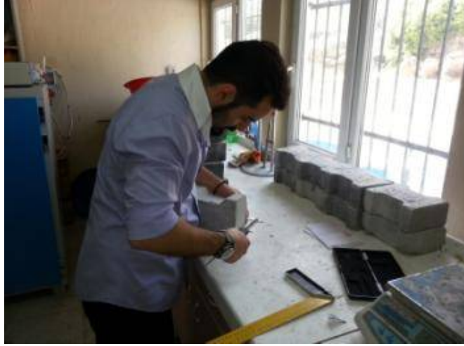
Şekil 3.25. Numune kalınlıklarının ölçülmesi
