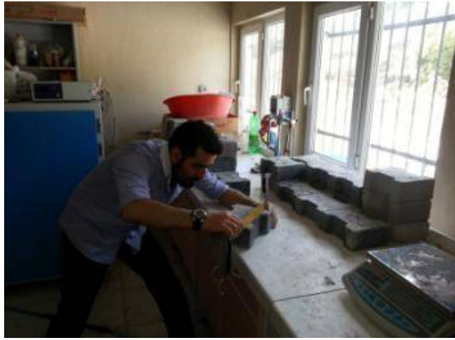
Şekil 3.26. Numunelerin düzlük ve bombelerinin ölçülmesi
