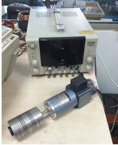
Şekil 5.5 : Sinyal jeneratörü ve kuplaj mekanizması.
