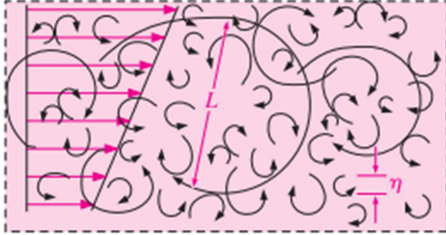
Fotoğraf 2. 12. En küçük ( \eta ) ve en büyük ( L ) Girdap görünümü [70]
