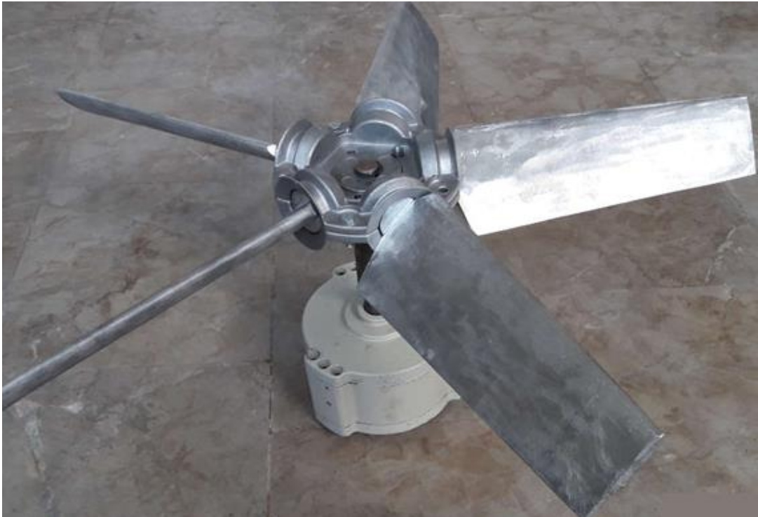
Şekil 2.8. Türbin kanatlarının rotora monte halinde (Ünal, 2019).
