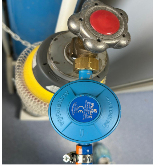
Şekil 6. CO tüpünden deney kabineine kontrollü gaz geçişini sağlayan aparat
