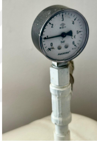
Şekil 6. CO tüpünden deney kabineine kontrollü gaz geçişini sağlayan aparat
