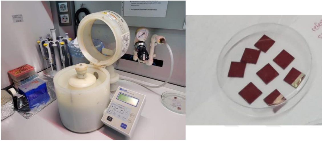
Şekil 3.4. İnce filmlerin hazırlanmasında kullanılan spin-kaplama sistemi ve kaplanan ince filmler.
