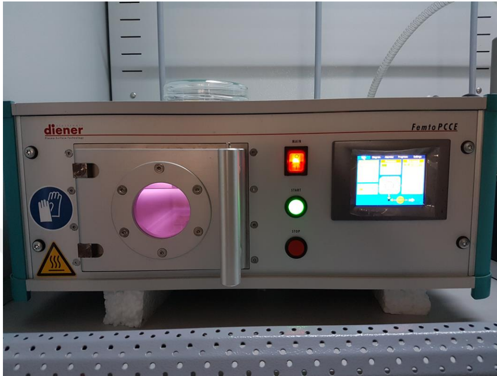
Şekil 3.2. Deneysel çalışmalarda kullanılan O 2 plazma sistemi.
