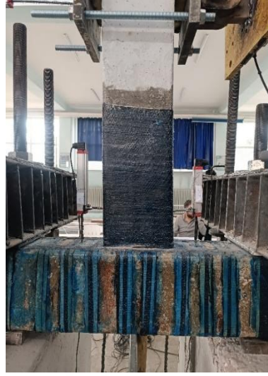
Şekil 4.31. %20COR+CFRP numunenin deney başlamadan önceki görüntüsü
