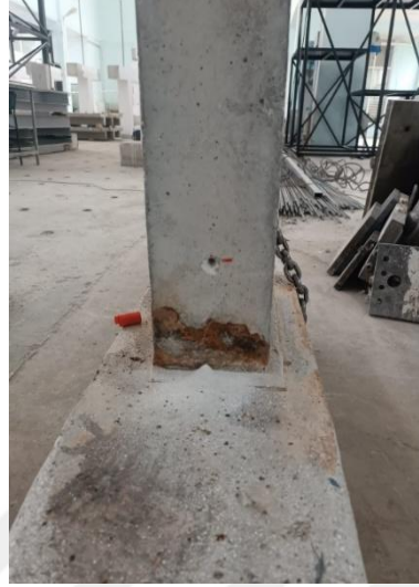
Şekil 4.16. REF+%20COR numunenin deney başlamadan önceki görüntüsü
