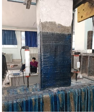
Şekil 4.78. Numunede +2. çevriminde meydana gelen ilk çatlak oluşumu
