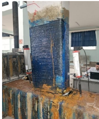
Şekil 4.54. Donatıların kopup deney sonuna ulaşılması
