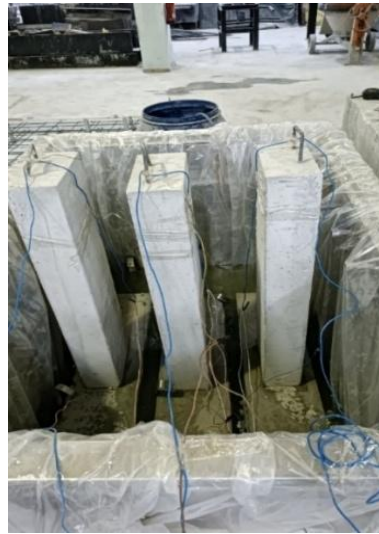
Şekil 3.11.%5'lik NaCl çözeltisi ile oluşturulan elektroliz ortam
