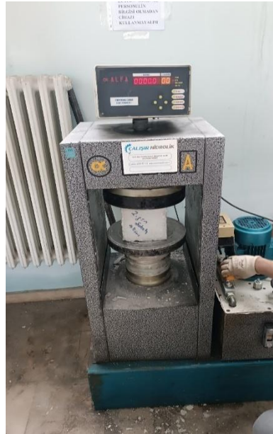
Şekil 3.2. Beton basınç dayanımı test cihazındaki numune görüntüsü
