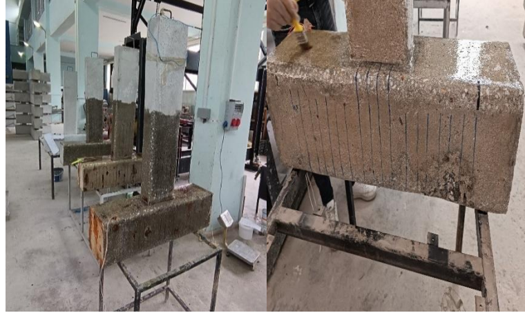
Şekil 3.36. Epoksi esaslı astar uygulama görüntüsü
