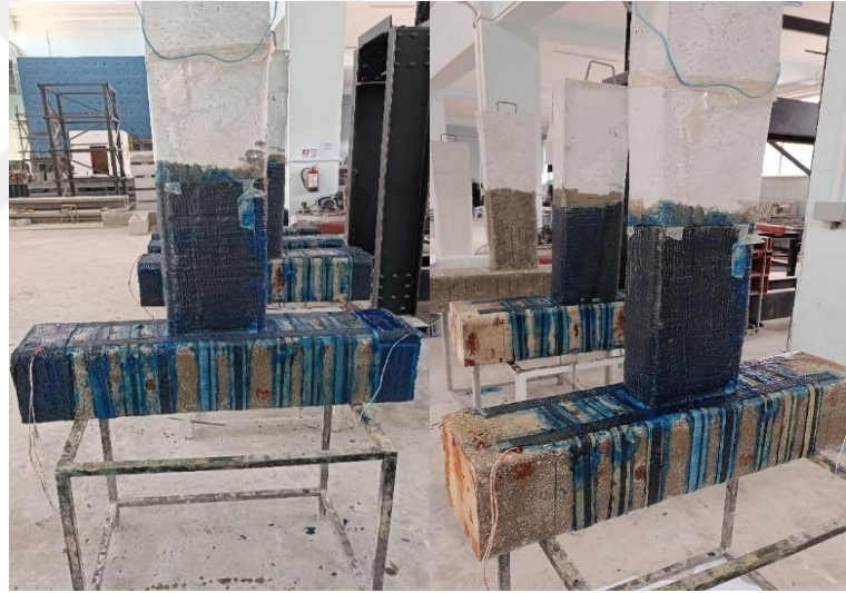
Şekil 3.40 Epoksi ve CFRP uygulama görüntüleri
