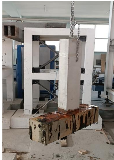
Şekil 3.18. %10COR+CFRP+%10 COR numunesinin 32. günde korozyon hasarı
