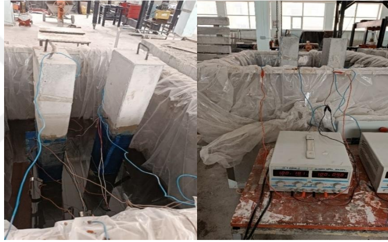
Şekil 3.43. Deney elemanlarının korozyon deneylerine başlama görüntüleri
