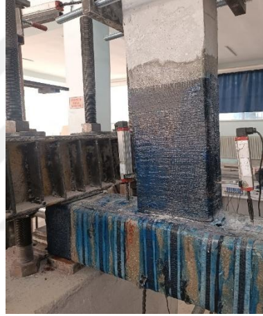
Şekil 4.80. Numunede meydana gelen CFRP'deki açılmalar
