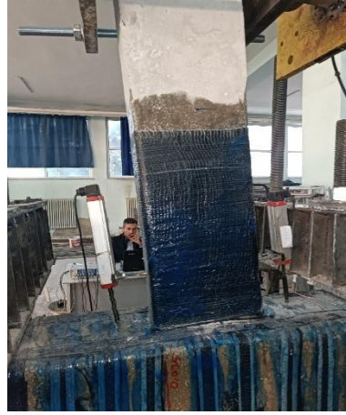
Şekil 4.82. Donatıların kopup deney sonuna ulaşılması
