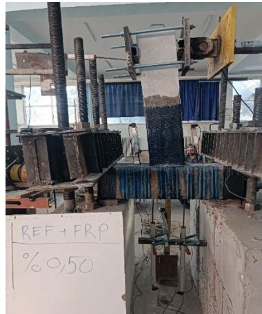
Şekil 4.84. Donatıların kopup deneyin sonlandırılması
