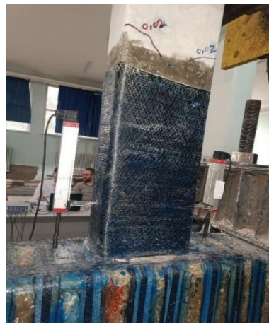
Şekil 4.39. Donatıların kopup deney sonuna ulaşılması
