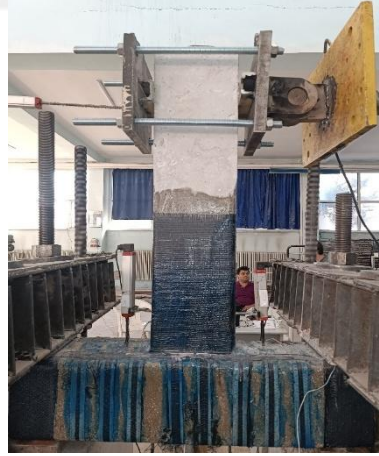
Şekil 4.77. REF+CFRP numunesinin deney başladıktan sonraki ilk çatlak oluşumları
