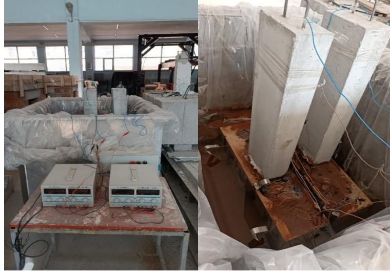
Şekil 3.21. REF+%20COR ve %20 COR+CFRP numunelerinin 64.gün korozyon hasarları
