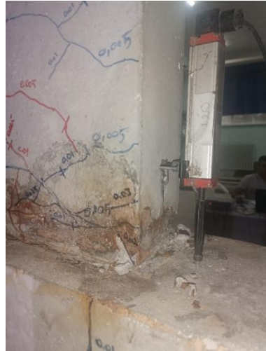
Şekil 4.23. Basınç bölgesinin ezilmesi
