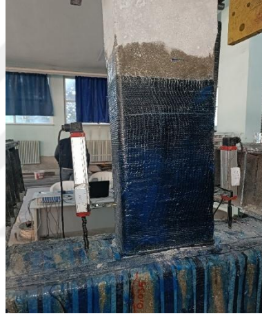
Şekil 4.83. Donatıların kopup deney sonuna ulaşılması
