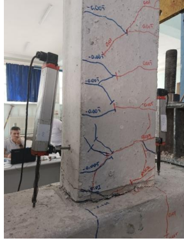
Şekil 4.8. Basınç bölgesinin ezilmesi
