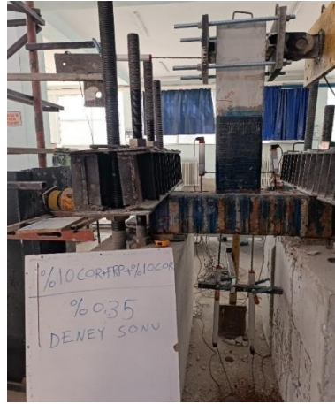
Şekil 4.69. Donatıların kopup deney sonuna ulaşılması
