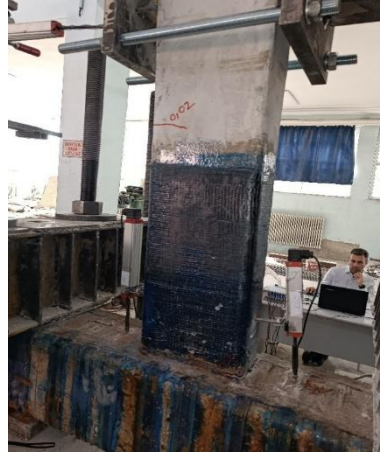
Şekil 4.66. +5. Çevrimde birleşim bölgesindeki çatlağın 2 mm kalınlığa ulaştığı görüntü
