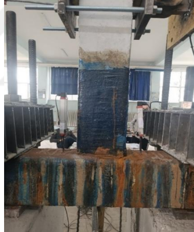
Şekil 4.49. CFRP+%20COR numunesinin deney başladıktan sonraki ilk çatlak oluşumları
