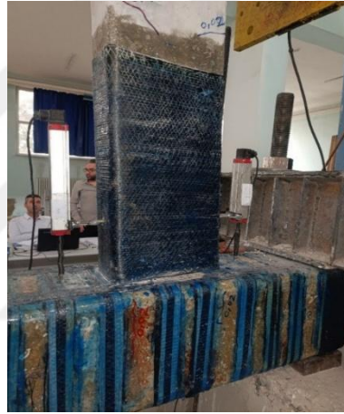
Şekil 4.38. CFRP'de oluşan ayrılmalar
