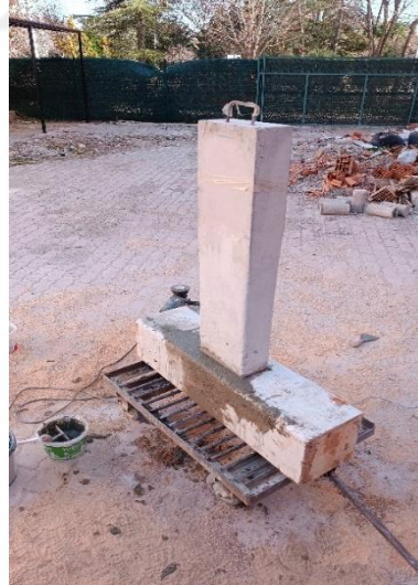
Şekil 3.24. Tamir harcı ile onarımı yapılan numune
