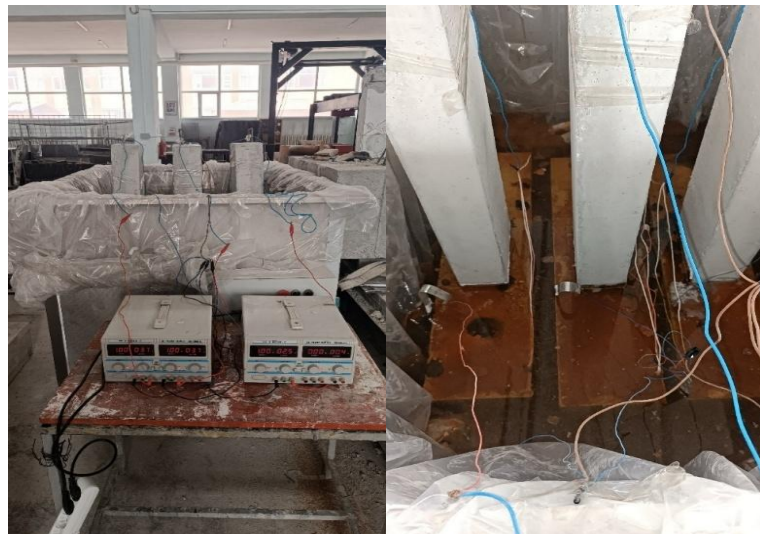
Şekil 3.15. Korozyon deneylerinde 14.gün
