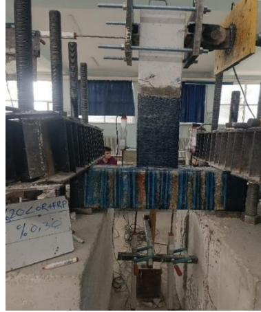
Şekil 4.40. Donatıların kopup deney sonuna ulaşılması
