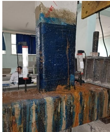
Şekil 4.51. Numunede meydana gelen CFRP'deki açılmaların 2 mm'yi geçtiği görülen -4 çevriminin görseli
