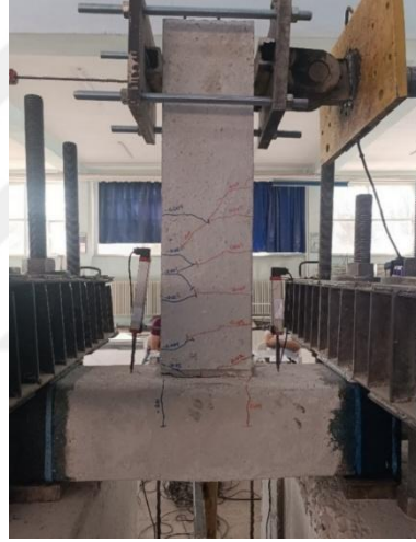
Şekil 4.6.Kolonda çekme anında meydana gelen ilk çatlak
