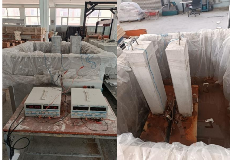
Şekil 3.20. REF+%20COR ve %20 COR+CFRP numunelerinin 50.gün korozyon hasarları
