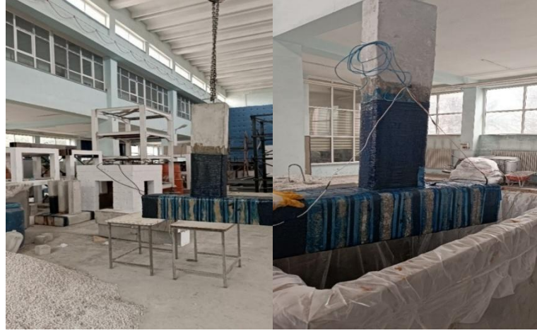
Şekil 3.42. Deney numunelerinin korozyon havuzuna yerleştirilme görüntüleri
