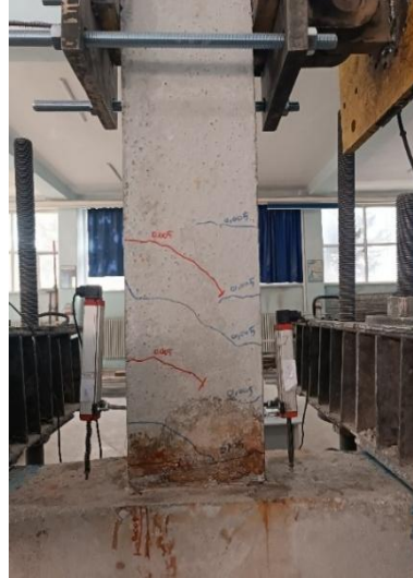
Şekil 4.20. Kolonda -1 çevriminde meydana gelen ilk çatlak
