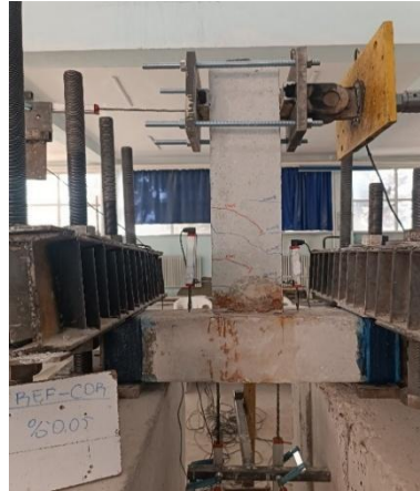
Şekil 4.19.REF+%20COR deney numunesinin deney başladıktan sonraki ilk çatlak oluşumları
