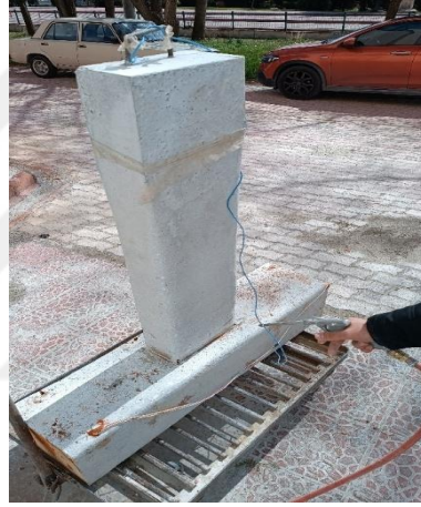
Şekil 3.28. Numune yüzeylerinin hava yardımıyla temizlenme işlemi
