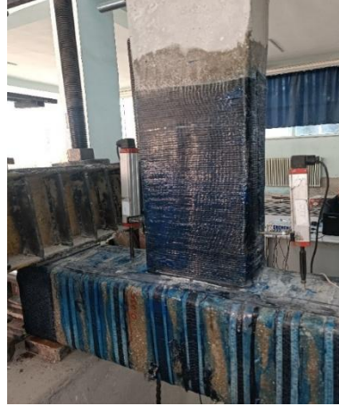
Şekil 4.79. CFRP'deki açılmaların 0.7 mm'yi geçtiği görülen +4 çevriminin görseli
