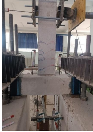
Şekil 4.4. Referans numunenin deney başladıktan sonraki ilk çatlak oluşumları
