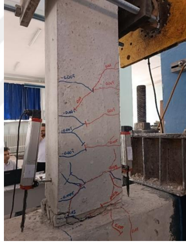
Şekil 4.9. Kabuk betonun dökülmesi
