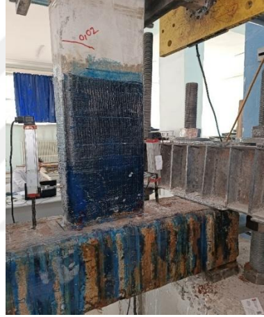
Şekil 4.67. Donatıların kopup deney sonuna ulaşılması
