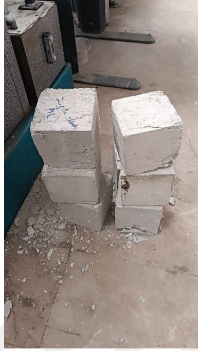
Şekil 3.3. Dayanım testi tamamlanmış numuneler
