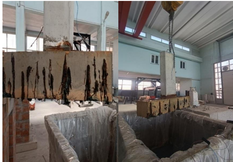
Şekil 3.22. REF+%20COR ve %20 COR+CFRP numunelerinin korozyon hasarlarının tamamlanmış görüntüsü
