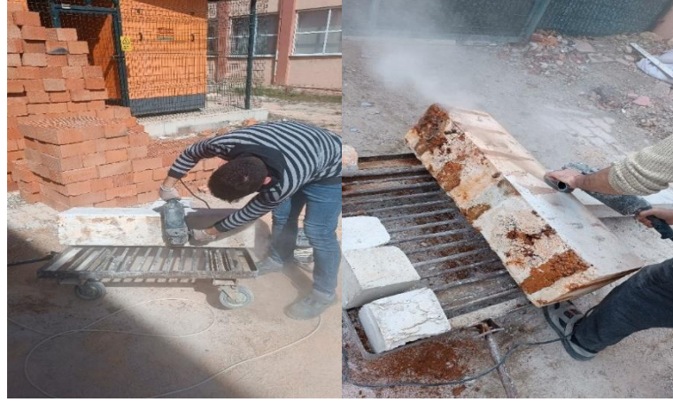
Şekil 3.27. Deney elemanlarının 135° pahlama işlemleri
