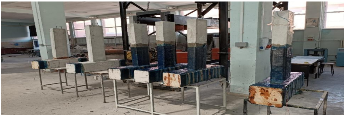
Şekil 3.41.CFRP kompozitinin deney numuneleri üzerine epoksi ile yapıştırılmış ve epoksi işlemi tamamlanmış görüntüsü
