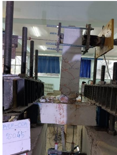
Şekil 4.26. Donatıların kopup deneyin sonlandırılması
