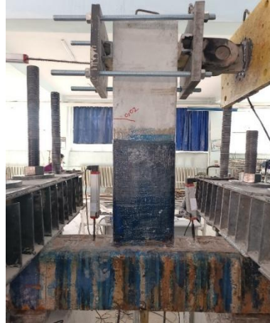
Şekil 4.68. Donatıların kopup deney sonuna ulaşılması
