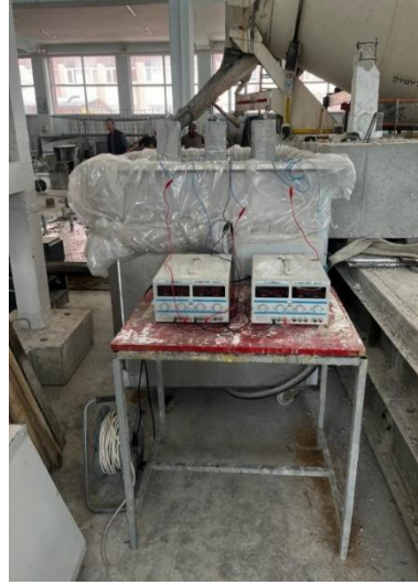
Şekil 3.12.Korozyon deneyleri için hazırlanan deney düzeneği
