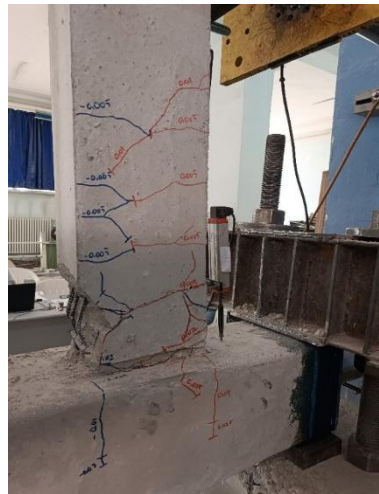
Şekil 4.10. Donatıların burkulmaya başlaması
