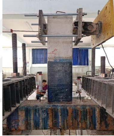
Şekil 4.64. Numunede meydana gelen CFRP'deki açılmaların 2 mm'yi geçtiği görülen +3 çevriminin görüntüsü
