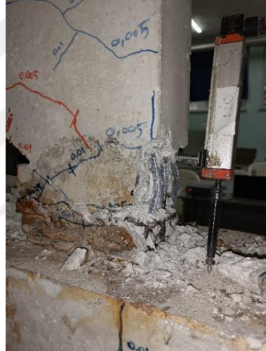
Şekil 4.25. Donatıların burkulmaya başlaması
