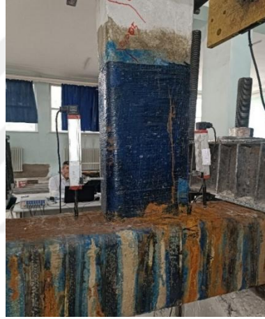
Şekil 4.53. +6. Çevrimde CFRP'deki açılmalar
