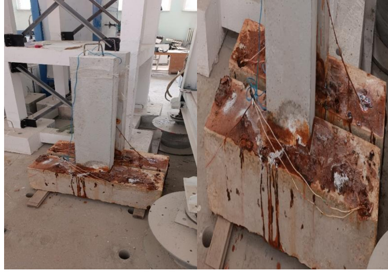
Şekil 3.23. REF+%20COR ve %20 COR+CFRP numunelerinin deney sonu görüntüleri
