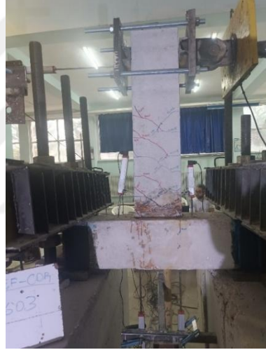
Şekil 4.22. Çatlakların birleşip uzamaya devam etmesi
