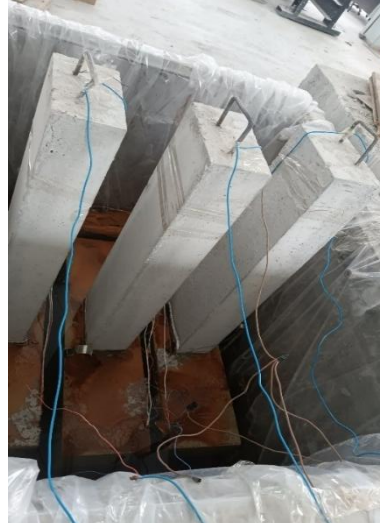
Şekil 3.14. Korozyon Deneylerinde 7.gün
