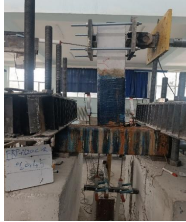
Şekil 4.55. Donatıların kopup deney sonuna ulaşılması
