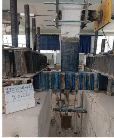
Şekil 4.34. %20COR+CFRP numunesinin deney başladıktan sonraki ilk çatlak oluşumları
