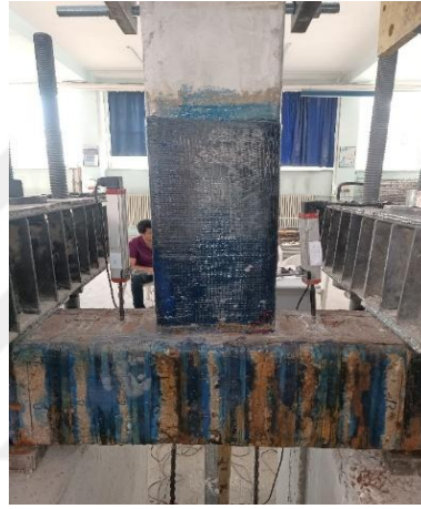
Şekil 4.60. %10 COR+CFRP+%10 COR numunenin deney başlamadan önceki görüntüsü
