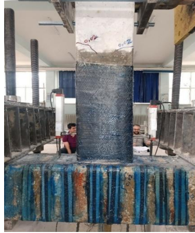
Şekil 4.37. CFRP'de oluşan ayrılmalar
