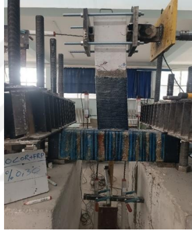
Şekil 4.41. Donatıların kopup deneyin sonlandırılması
