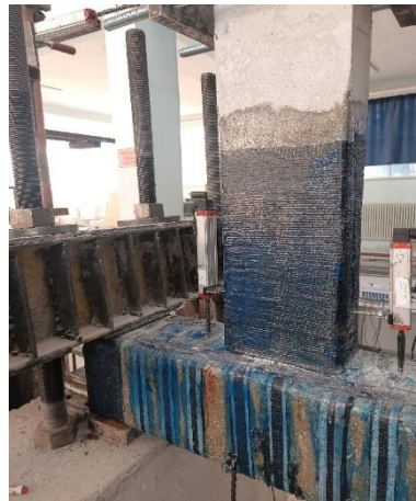
Şekil 4.81. Numunede meydana gelen CFRP'deki açılmalar
