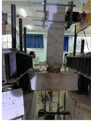
Şekil 4.24. Kabuk betonun dökülmesi
