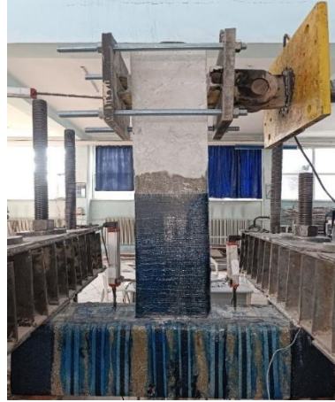
Şekil 4.74. REF+CFRP numunenin deney başlamadan önceki görüntüsü
