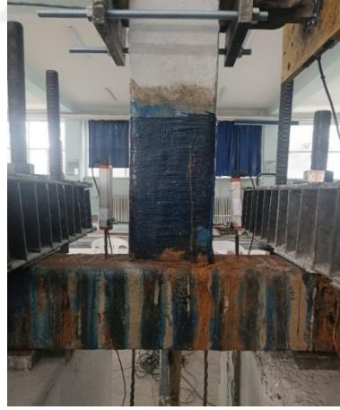
Şekil 4.46. CFRP+%20COR numunenin deney başlamadan önceki görüntüsü
