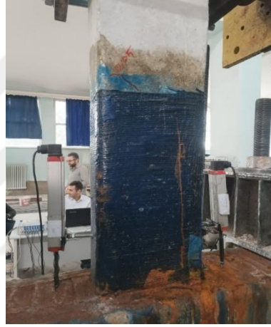
Şekil 4.50. Numunede-1. çevriminde meydana gelen ilk çatlak oluşumu
