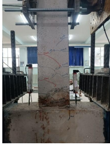
Şekil 4.21. Kolonda +2 çevriminde meydana gelen ilk çatlak
