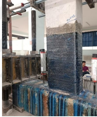
Şekil 4.35. Numunede +4 çevriminde meydana gelen ilk çatlak oluşumu
