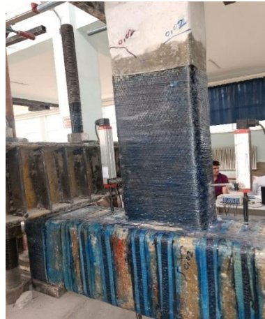
Şekil 4.36. Numunede meydana gelen ikinci çatlak oluşumu
