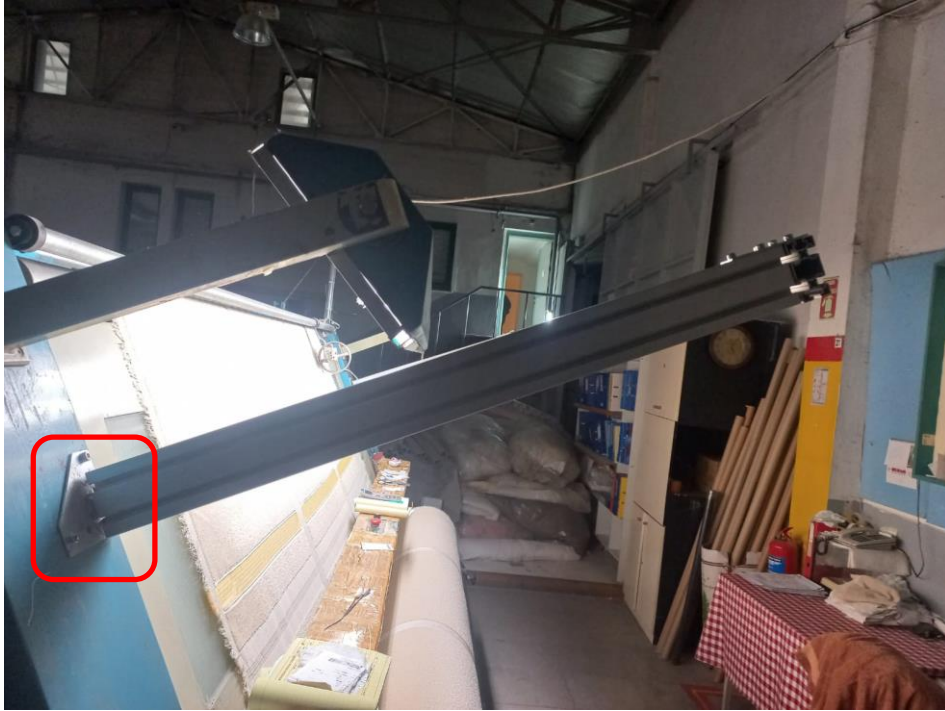
Şekil 4.9. Sigma profillerin kalite kontrol makinesi üzerindeki montajı (yan profilden görünüş ve tezgaha montaj edilmesi).
