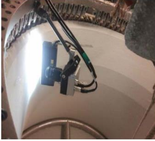
Şekil 2.7. Örgü Sistemi ve gerçek zamanlı hata tespit sisteminin genel yapısı (Hanbay vd., 2017).
