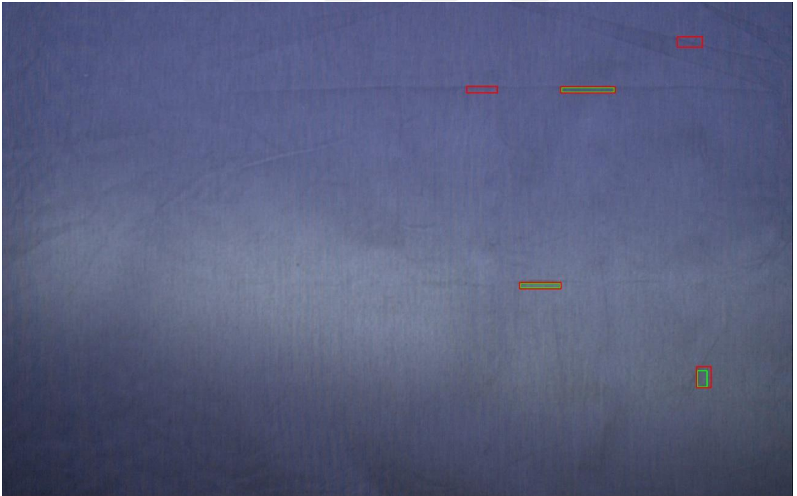
Şekil 5.12. Sistemin yakaladığı atkı hatası ve kırış örnekleri (Atkı Hatasında Uzunluk Büyük Olduğundan Sistemi Yormamak İçin Küçük Dikdörtgenler Konulmuştur.).
