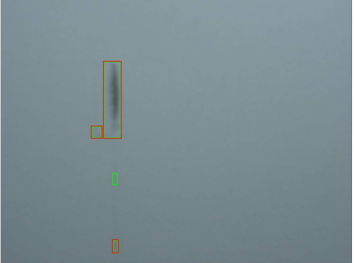
Şekil 5.16. Sistemin yakaladığı tahar hatası örneği.
