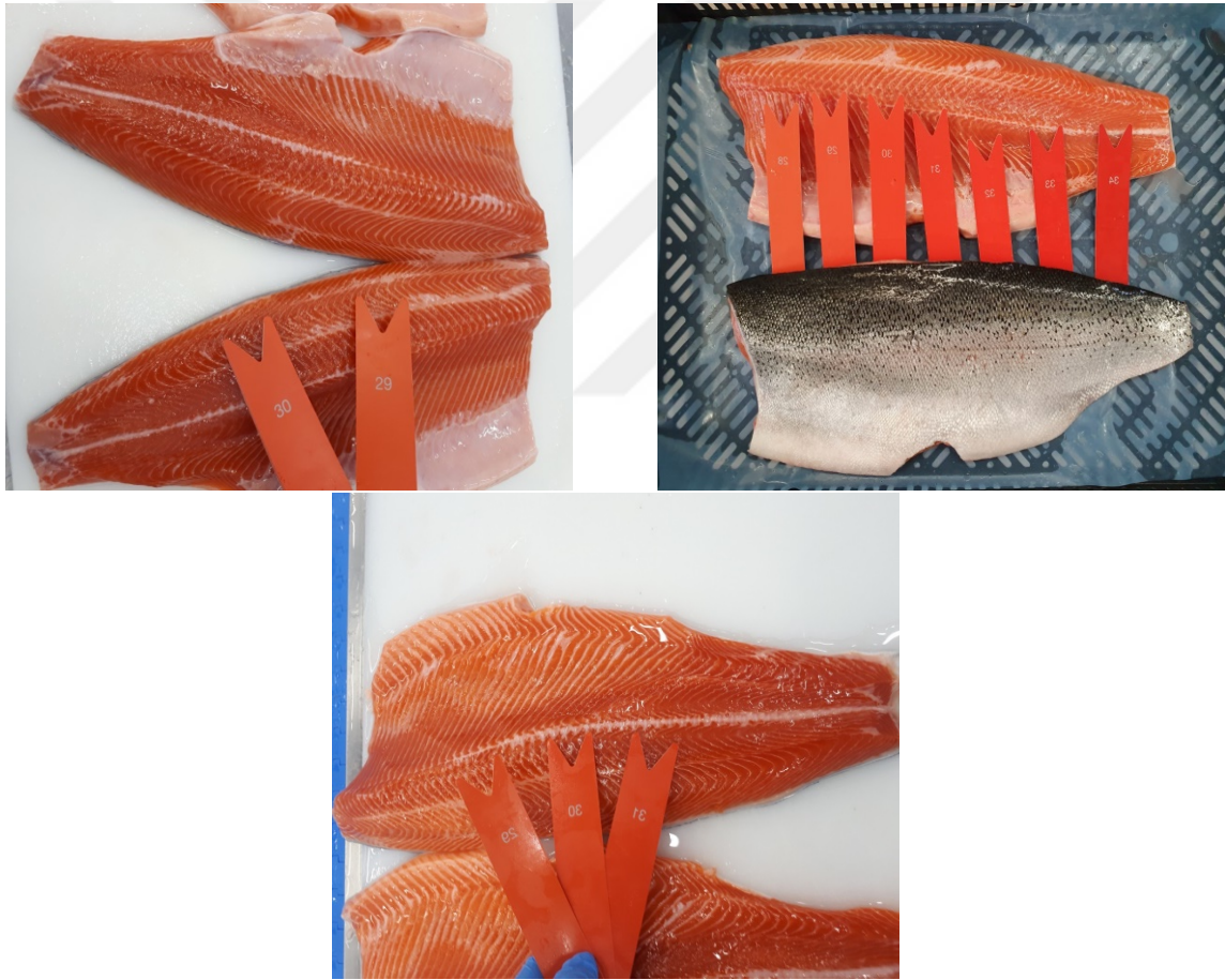
Şekil 3.8. DSM SalmoFan™ Renk Kartellası ile Renk Ölçümü
