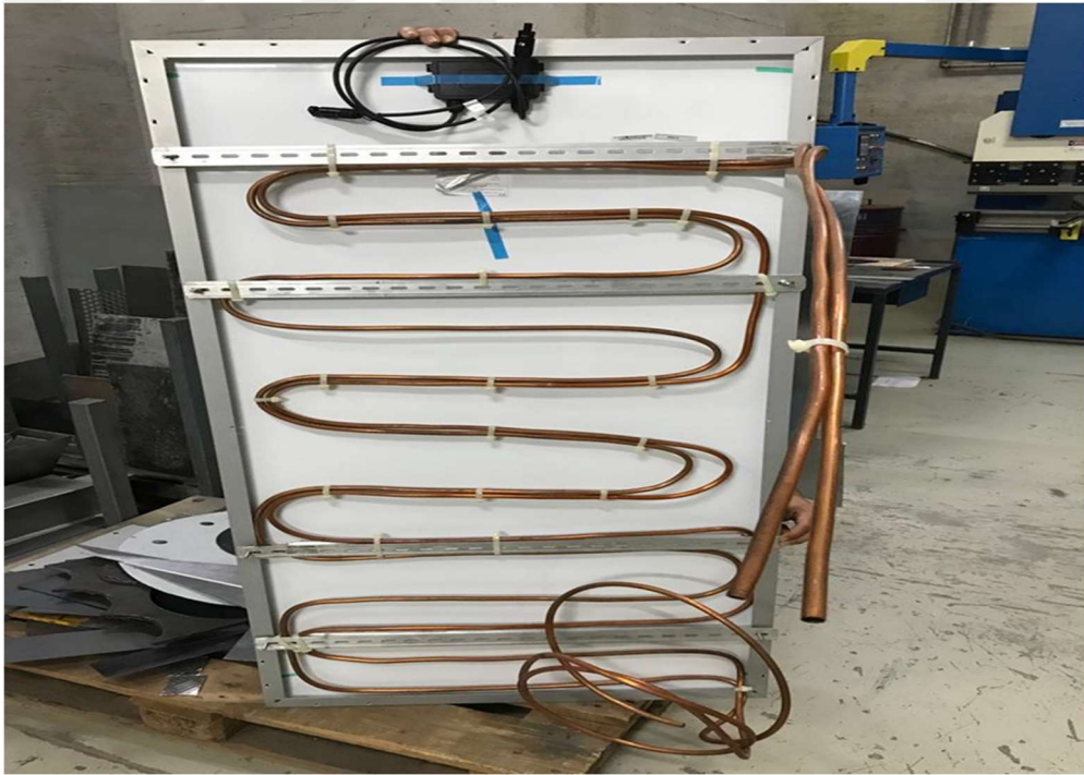
Şekil 5.4 Bakır Borunun Panelin Arka Kısımına Montajı
