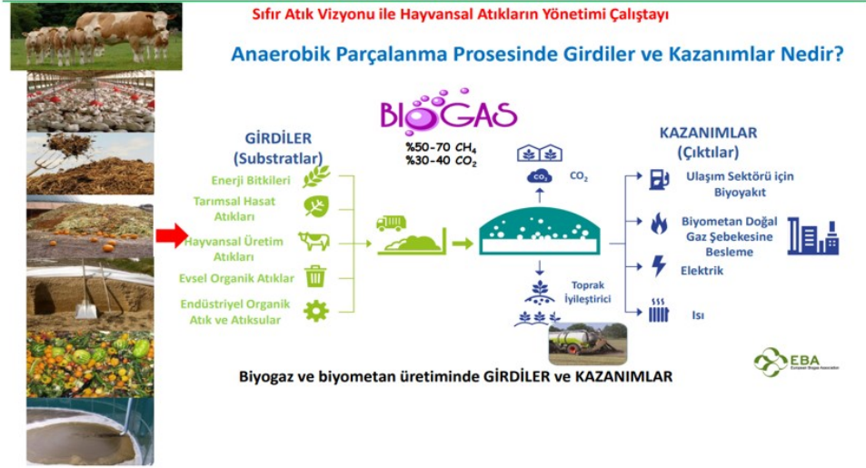
Şekil 5.17. Anaerobik Arıtım Şeması
