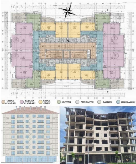
Görsel 3.123. Güngör Caddesi 10 No.lu Yapı, Tip Kat Planı ve Cadde Cehesi (Kaynak: YBA; HİE Arşivi)
