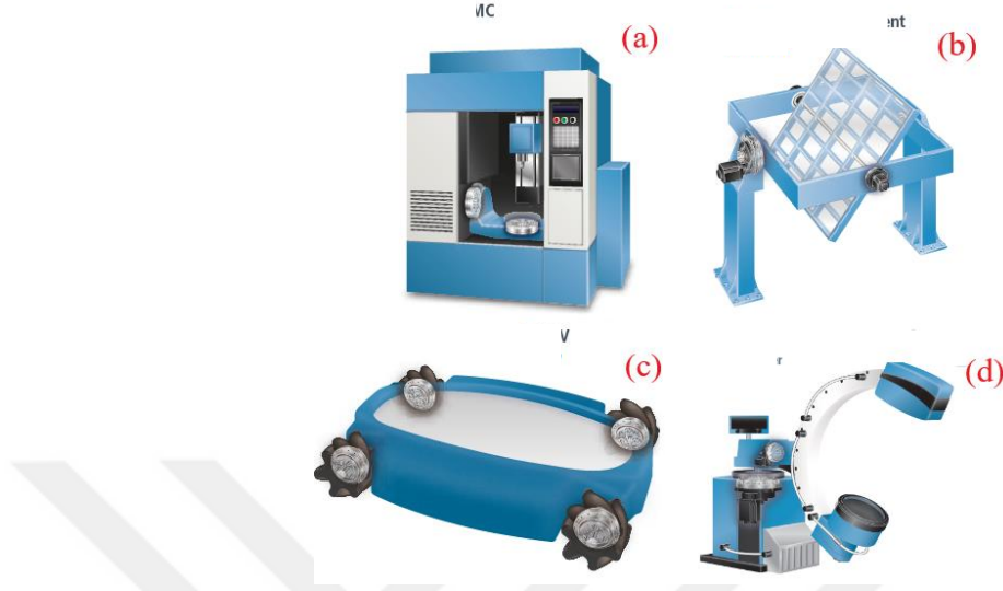
Şekil 1.5: Sikloid redüktör kullanım alanları örnekleri: (a) CNC tezgahı eksenleri; (b) Fikstür eksenleri; (c) AGV robot tekerleri; (d) Sağlık tarama cihazlarının eksenleri (Nabtesco, 2020).
