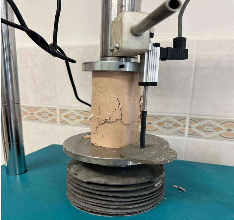
Şekil 4. 13. Serbest basınç deneyinde Yük dayanım Belirlenmesi
