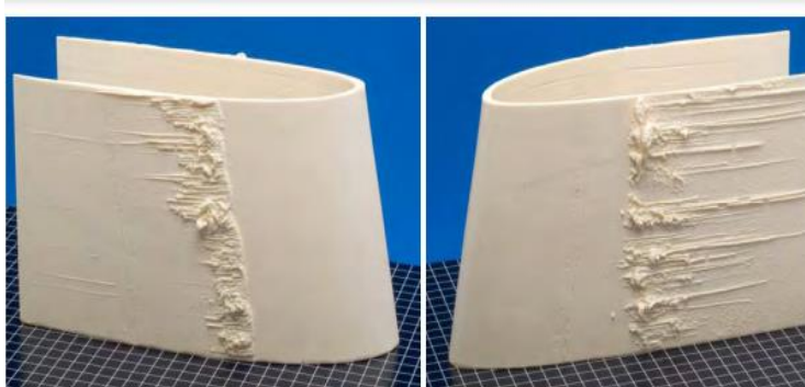
Şekil 3.10. Kanadın alt ve üst yüzeyinde yeniden buzlanma birikimi [29]
