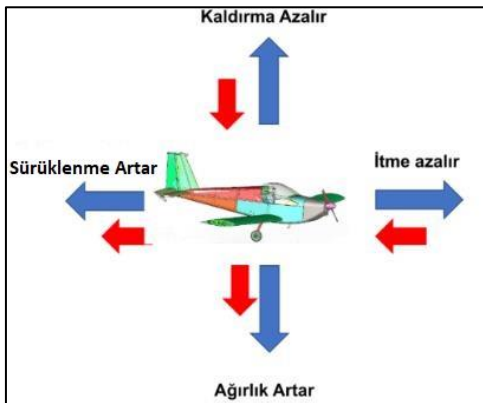
Şekil 1.1. Buzlanmanın uçuş performansına etkisi
