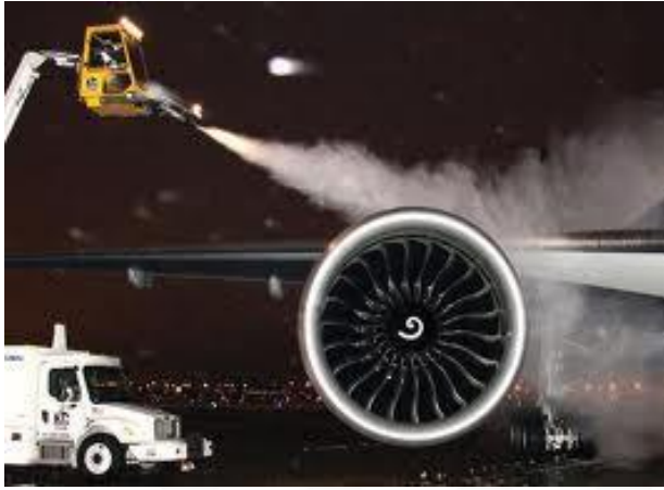
Şekil 1.3. Bir uçaęa uygulanan buzlanma önleyici işlem [2]
