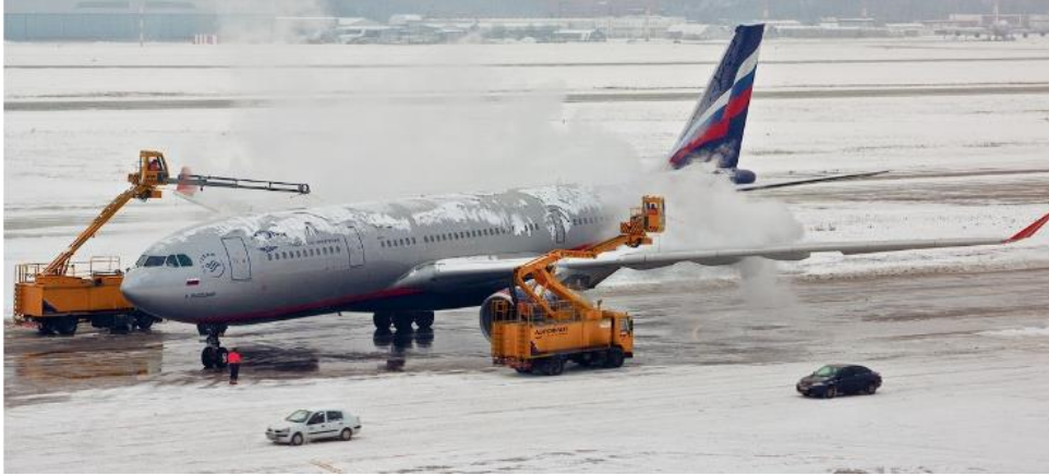
Şekil 1.2. Bir uçak üzerindeki buz birikimi giderme işlemi [1]
