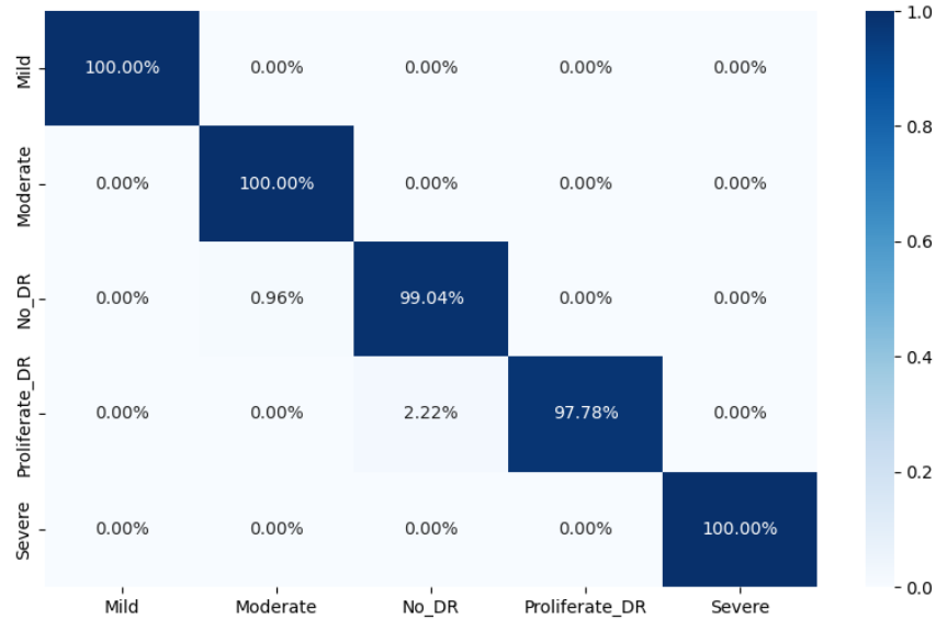
Şekil 6.34. MobileNetV2 modelinin beş sınıflandırılmalı ve Gaussian filtreli veri kümesinden elde edilen karışıklık matrisi
