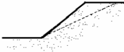
Şekil 3.18 Duraylılığın, Şev Oranının Arttırılması ile Sağlanması (Akçakal, 2009).
