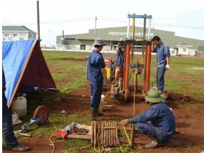
Şekil 3.32 CPT Deneyi Saha Örneği
