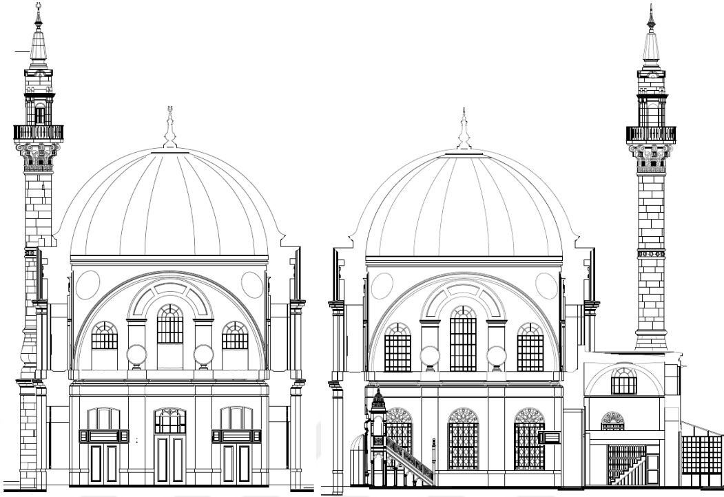
Şekil 2.294 Altunizade Camisi'nin kesitleri, rölöve (VGM II. Bölge Arşivi)
