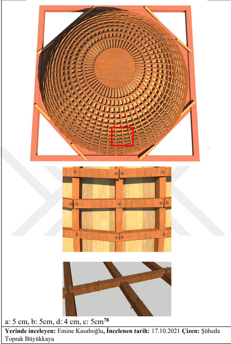
Şekil 3.32 Ahrida Sinagogu'nun 17. yüzyıl sonu- 18. yüzyıl başına tarihlenen ahşap kubbesinin konstrüksiyonu ve düşey kaburga ve yatay ahşap elemanların birleşim detayı
