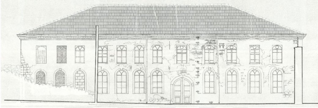
Şekil 2.7 Ahrida Sinagogu'nun arka cephesi, rölöve (Atatürk Kitaplığı Arşivi)
