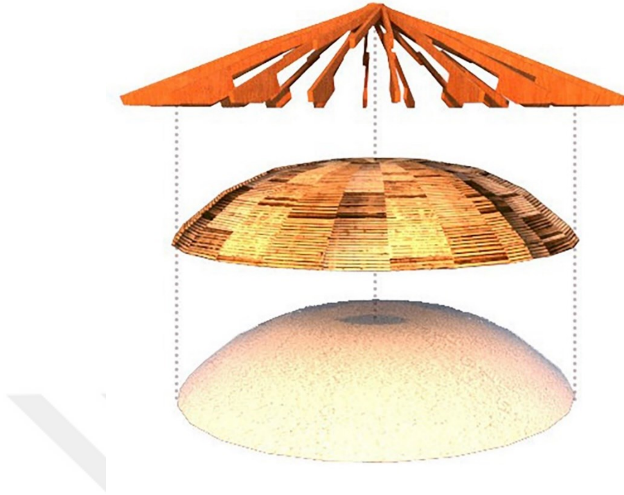
Şekil 3.16 Yahya Efendi Camisi’nin ahşap kubbesinin katmanlarının gösterimi (Çizim: Şüheda Toprak, 2023)
