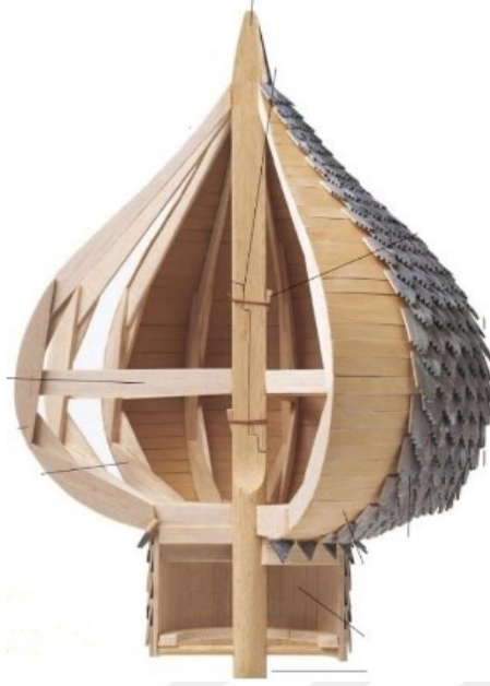
Şekil 1.4 Rusya’ da kullanılan ahşap soğan kubbe konstrüksiyonu (Ashkova, 2022)
