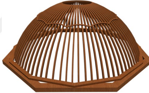
Şekil 3.28 Takkeci İbrahim Ağa Camisi'nin 16. yüzyıla tarihlenen ahşap kubbesinin özgün yapım aşamaları
