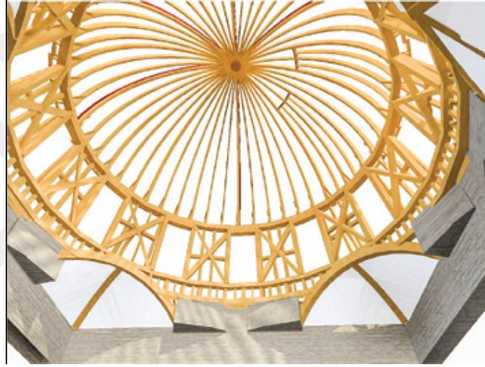
Şekil 3.45 Cezayirli Gazi Hasan Paşa Camisi’nin ahşap kubbesinin üç boyutlu modeli (Kocatürk vd., 2013)
