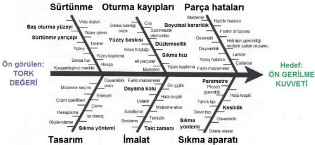
Şekil 2.18 : Tork ile ön gerilme kuvveti arasındaki balık kılçığı diyagramı
