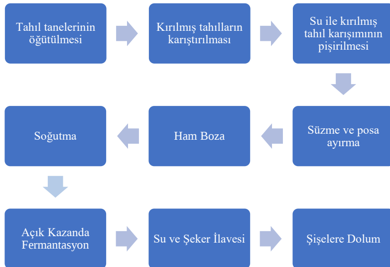
Şekil 3.3. Boza üretim akış şeması (Akpınar-Bayizit vd., 2010; R. Cholakov vd., 2016)
