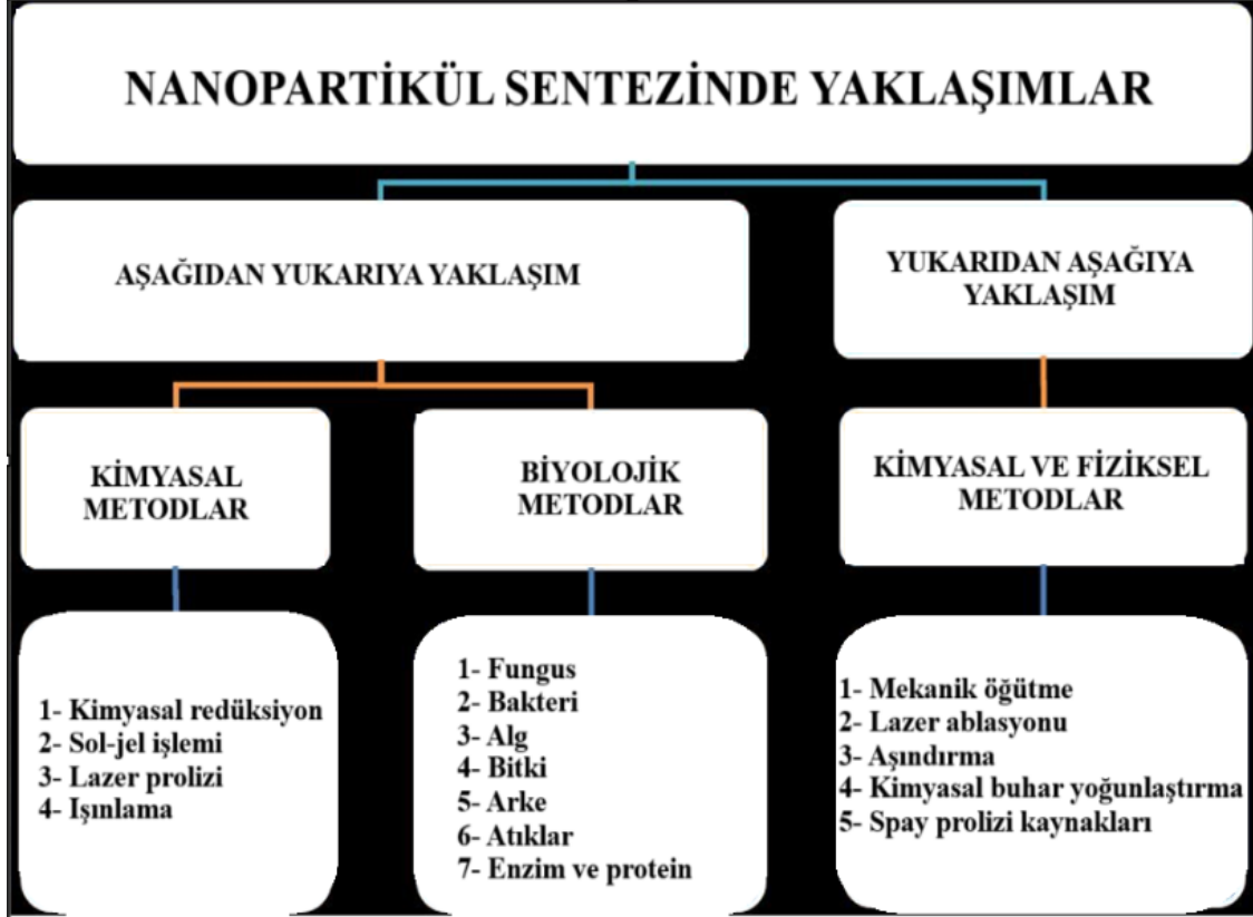
Şekil 3: Nanopartikül sentezinde kullanılan aşağıdan yukarı ve yukarıdan aşağı yaklaşımlarının metotları, bu metotlarda kullanılan başlıca yöntemler (Eraslan, 2020).
