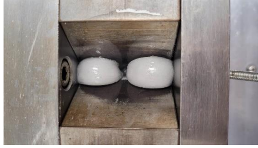
Şekil 4.2: Ağ. %50-50 oranında hazırlanan COC/PIB harmanının karıştırma prosesine ait fotoğraf.
