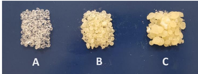
Şekil 3.3: PSA film hazırlanmasında kullanılan katı hammaddeler [A: COC elastomer, B: Rosin reçine (RE), C: Sikloalifatik hidrokarbon reçinesi (C5)]
