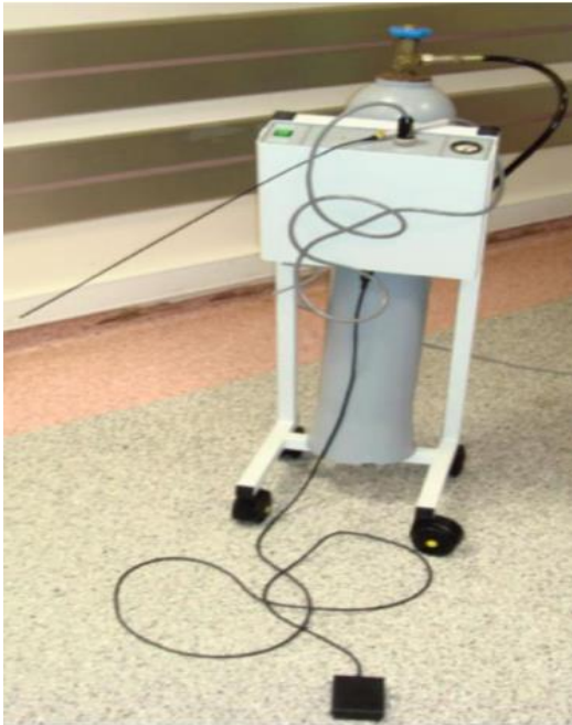
Şekil 3: Kriyo Ekipmanları; Kriyo Probu ve Kriyojen Madde (soğutma maddesi)
