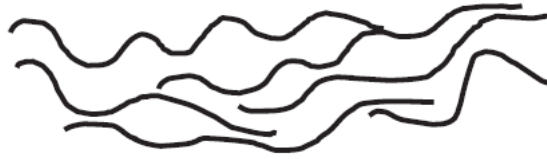
Şekil 2. 10. Termoplastik malzemenin moleküler yapısının şematik gösterimi (Biron, 2018).
