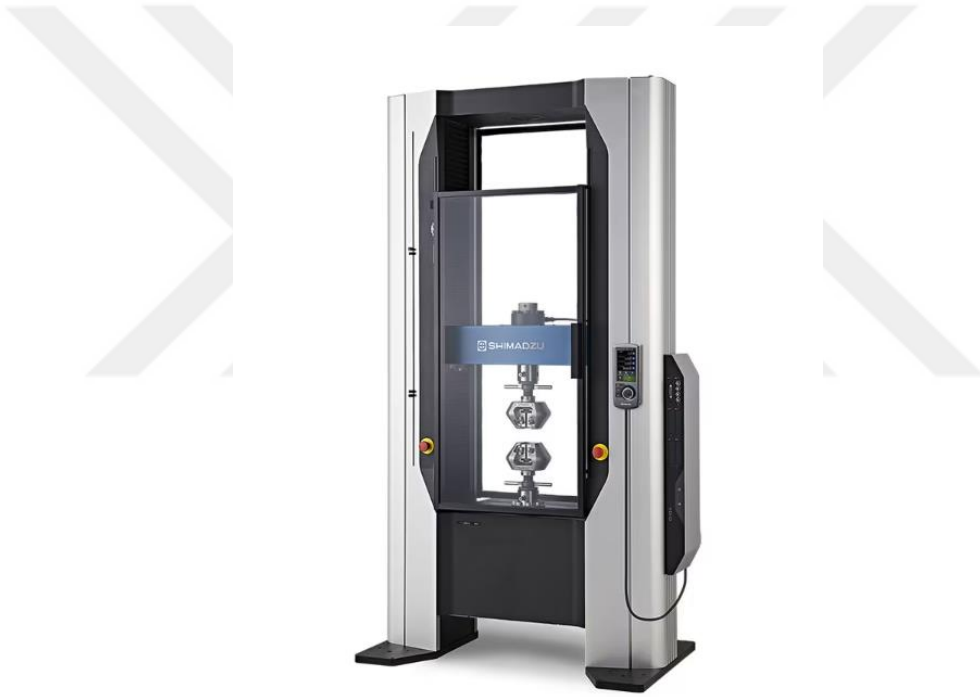
Şekil 4. 3. "Shimadzu AG-X " marka çekme test cihazı.
