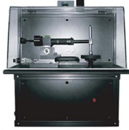
Şekil 4. 4. ‘‘Nanovea’’ marka aşınma test cihazı.
