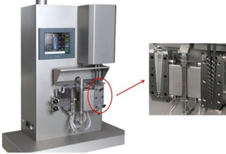
Şekil 4. 1. Laboratuvar tipi mikro karıştırıcı (DSMXplore, Hollanda).
