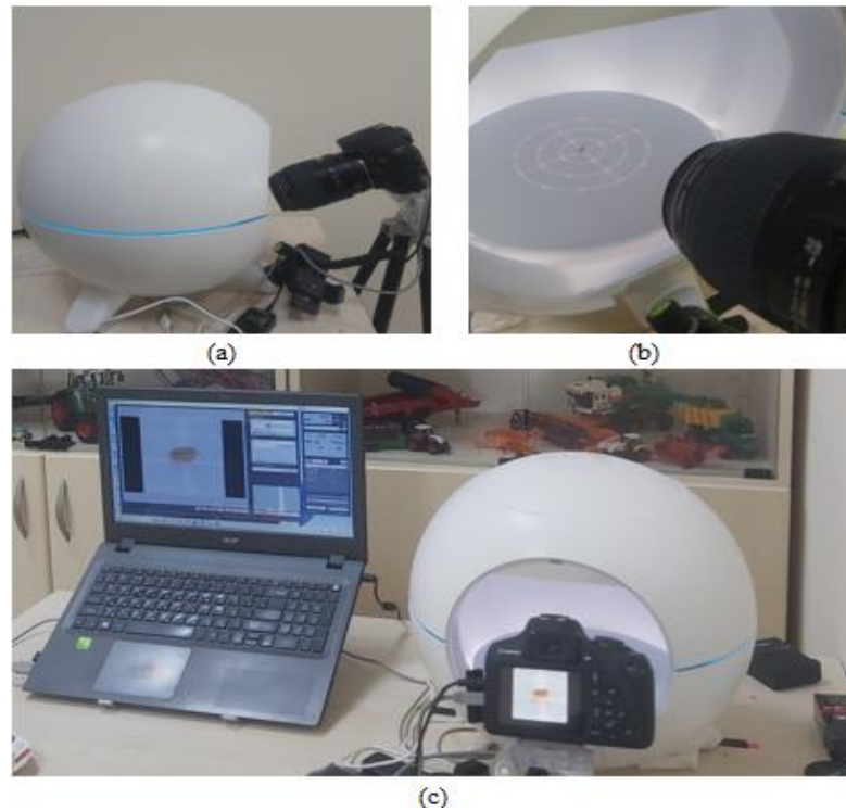
Şekil 3.3. (a) Foldio-360 platformu ile kamera, (b) Buğday tanesinin yerleştirildiği döner tabla, (c) Görüntü alma sisteminin genel görünümü
