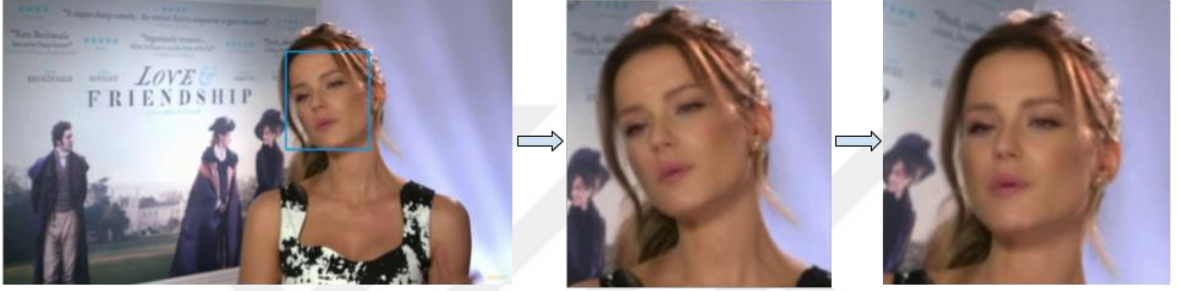
Şekil 19. Ön işleme adımında yapılan işlemler. MTCNN ile yüzün tespit edilmesi ve 256x256 piksel boyutunda görüntü kırılması. Ardından FAN ile yüzün hizalanması
