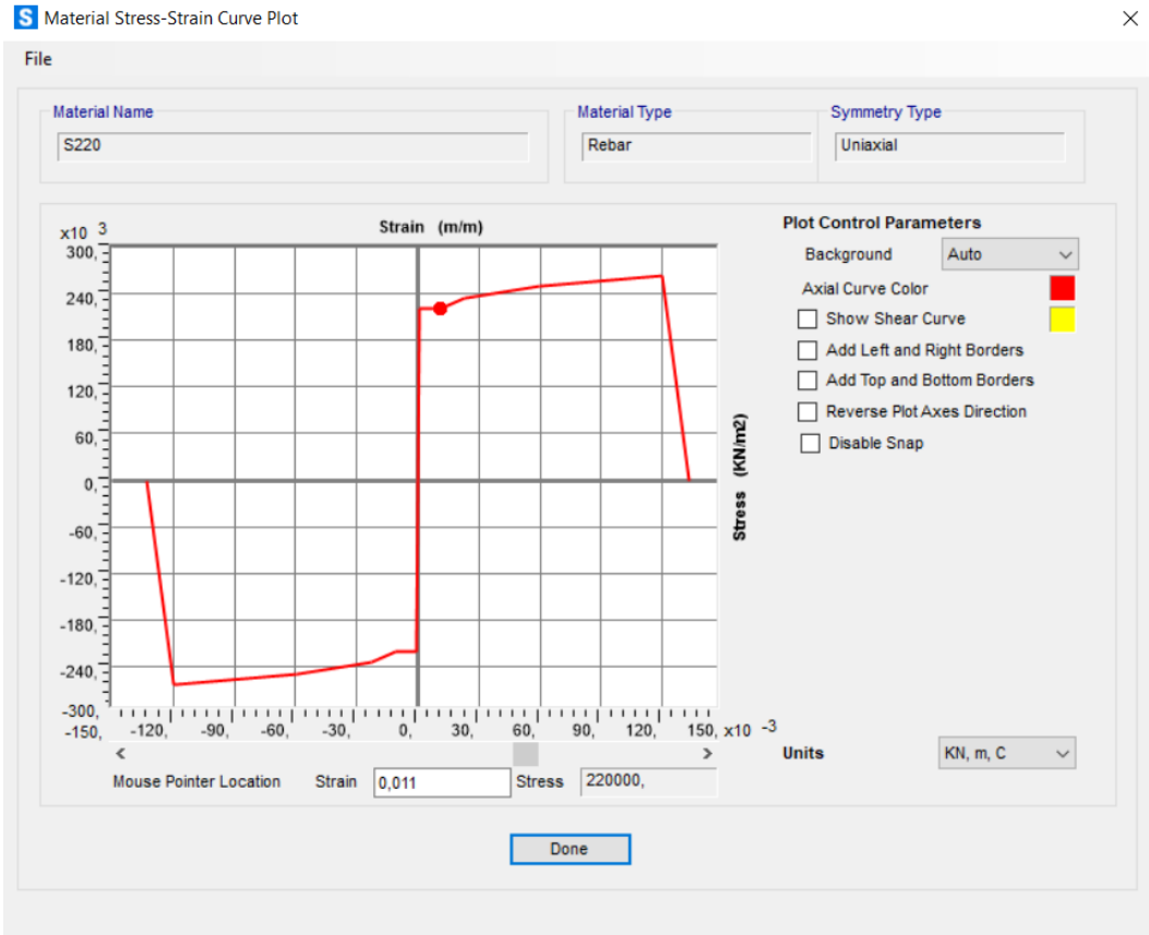
Şekil 4.8. S220 çeliği için malzeme modeli
