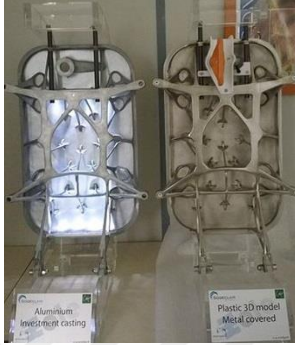
Şekil 2. 11: Bağlayıcı püskürtme (BJ) yöntemi ve hassas döküm yöntemiyle üretilen uçak kapısı (voxeljet, 2023).
