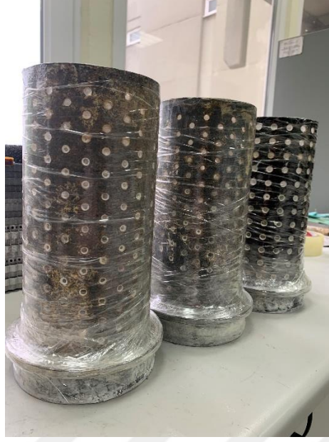
Şekil 2. 18: Etrafı bantlanmış 120mm çapında 260mm yüksekliğinde fanuslar.
