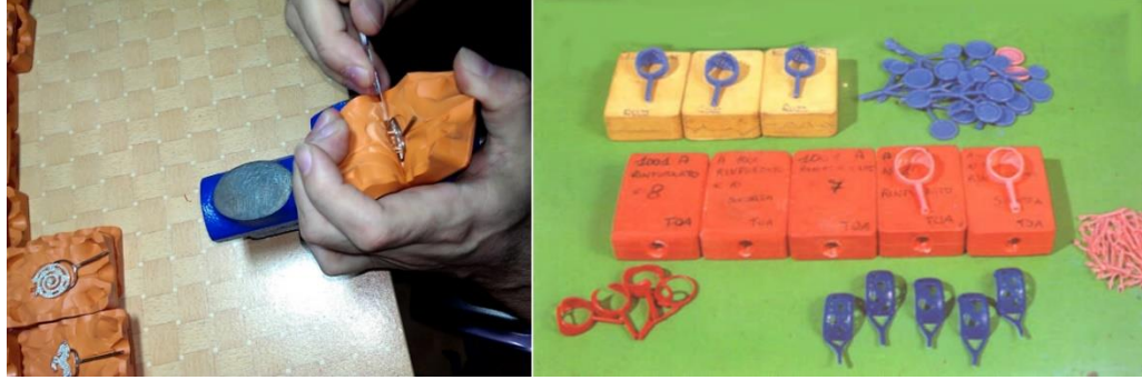
Şekil 2. 16: kauçuk kalıbından çıkarılan metal modeller ve mum modeller (Milli Eğitim Bakanlığı, 2006).
