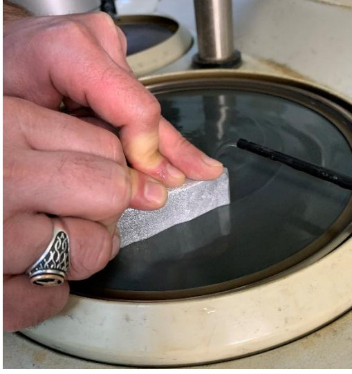
Şekil 3. 17: 800 gritlik zımpara ile zımparalama işlemi.
