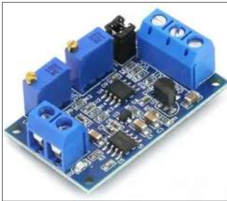
Şekil 2.11. Akım gerilim dönüştürücü devresi
