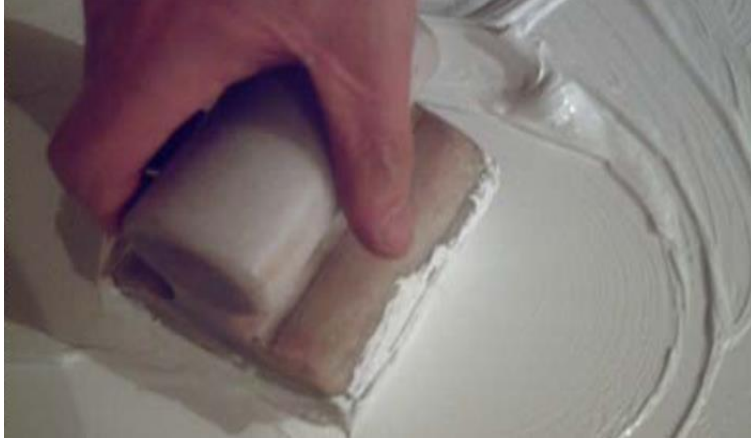
Resim 2.36. Deste-seng (el taşı) ile boya ezme işlemi. (Kaynak: Bozdağ, 2018, s.39).
