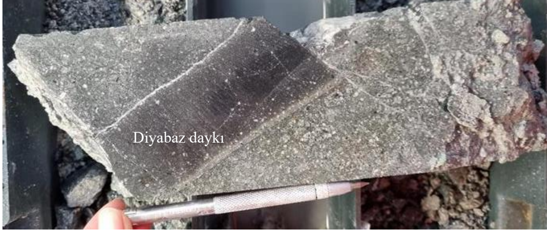
Şekil 6.6. Sondajın 178. metresine ait karot numunesi ve plajiyoklaz+biyotit+amfibol içeren altere andezit porfiri birimini kesen ince taneli bazaltik dayk
