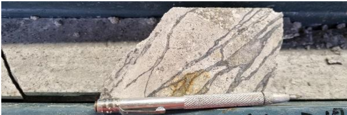
Şekil 6.16. Balya kuzeyi sondajının 549.5 metre derinliğinde gözlenen ve molibdenit içeren ağsal damarlar.
