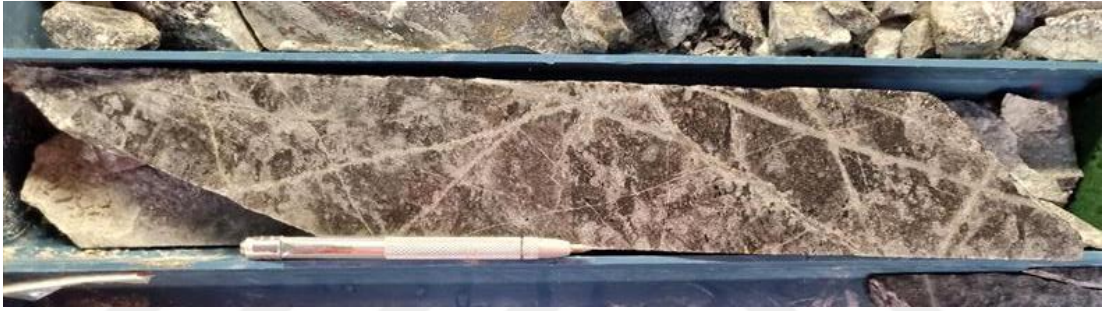
Şekil 6.18. Balya kuzeyi sondajının 1178 metrede gözlenen ağsal damarlar şeklinde gözlemlenen D damarları ve yoğun biyotit içeren altere granodiyorit birimi
