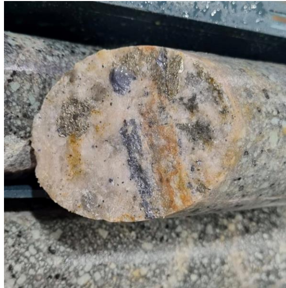
Şekil 6.19. Sondaj karotlarında gözlenen molibdenit-pirit damarları ve yoğun plajiyoklaz, biyotit/amfibol mineralleri içeren altere granodiyorit porfiri birimi
