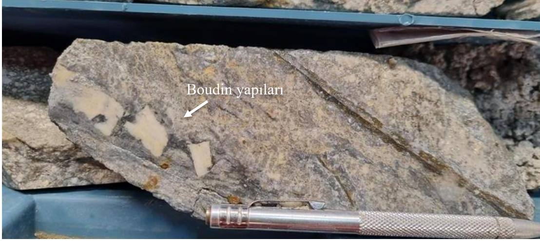
Şekil 6.10 Sondajın 940 metrelerine ait karot numunesi, gerilme tektoniği göstergesi olabilecek Boudin yapıları
