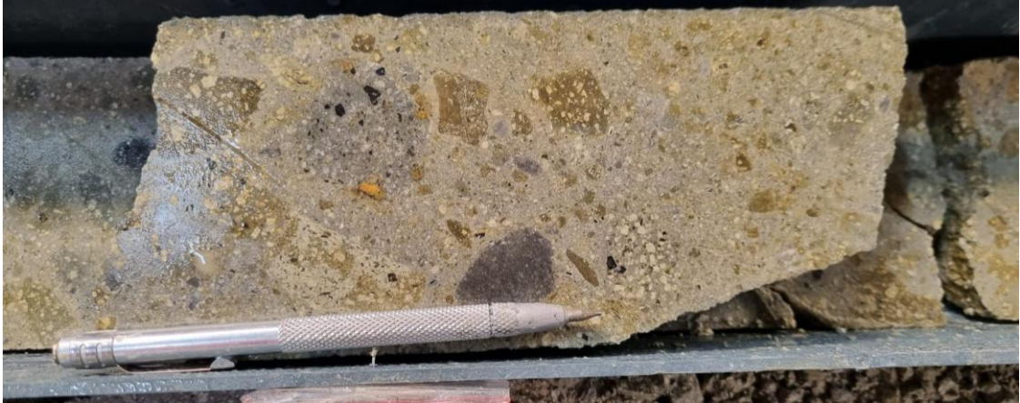
Şekil 6.5. Sondajın 92.8 metresine ait karot örneği içerisinde gözlenen aglomera/volkanik breşler
