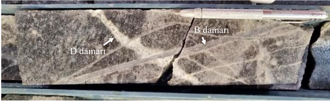
Şekil 6.17. Balya kuzeyi sondajının 1052.5 metre derinliğinde gözlenen D (kuvars-serizit-pirit) damarını kesen B damarı ve yaygın biyotit içeren altere granodiyorit porfiri yan kayaç.
