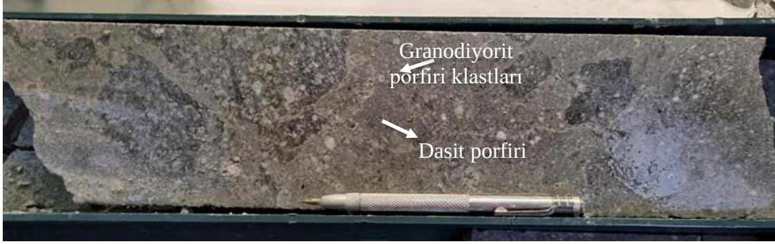
Şekil 6.7 Sondajın 437.50 metresine ait karot numunesi (dasit porfiri ve granodiyorit porfiri olmak üzere iki farklı porfir)
