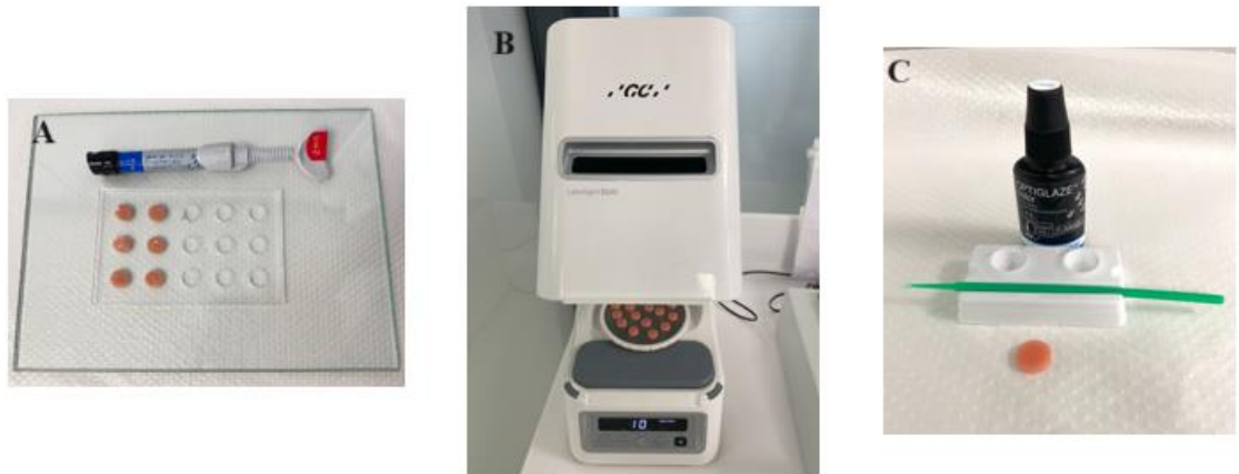
Şekil 3.4. A) İndirekt kompozit rezin örneklerin kalıp ile hazırlanması görüntüsü. B) Labolight DUO cihazı görüntüsü C) Yüzey polisajı tamamlanan örneklere uygulanan Optiglaze görüntüsü
