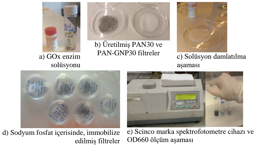
Şekil 3.6 : GOx enzim immobilizasyon prosesi.
