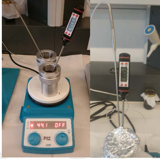
a) Düzenekteki su sıcaklığı 40 °C dereceye ayarlanırken.
