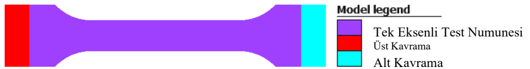
Şekil 2.3. Tek eksenli çekme testi simülasyonu için oluşturulan FEA modeli
