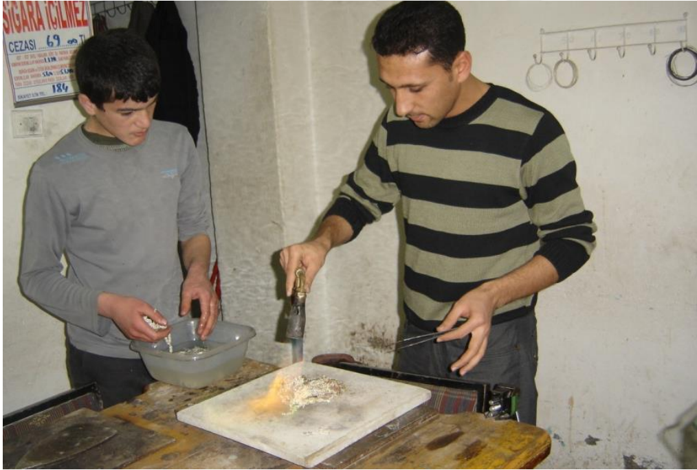
EK- 5. 20. Asit içinden çıkarılan ürünlerin üzerindeki boraks kalıntılarının ateşle temizlenme işlemi
