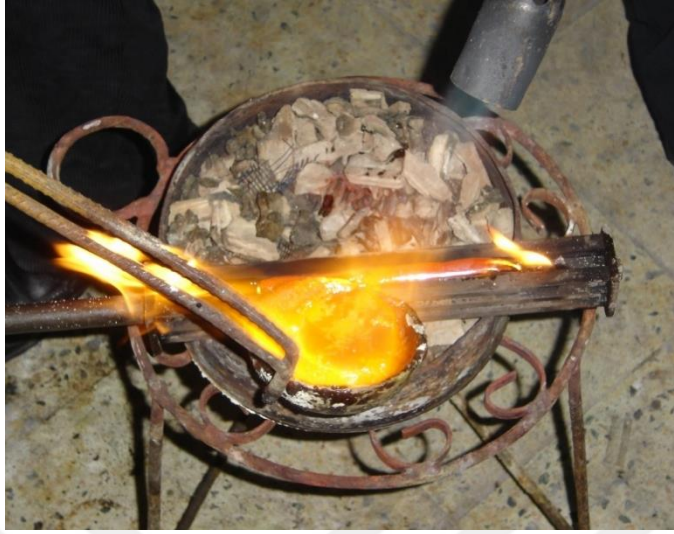
EK- 5. 11. Eritilen gümüşün çubuk dereceye dökülmesi ve çubukların dereceden çıkarılması
