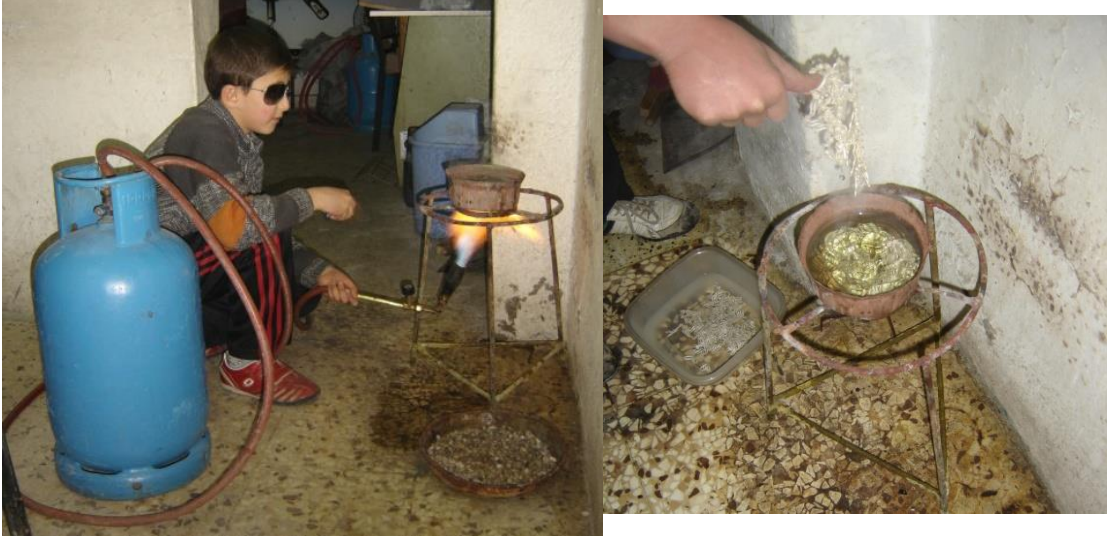
EK- 5. 19. Kaynak yapılan ürünlerin asitli suda kaynatılması işlemi
