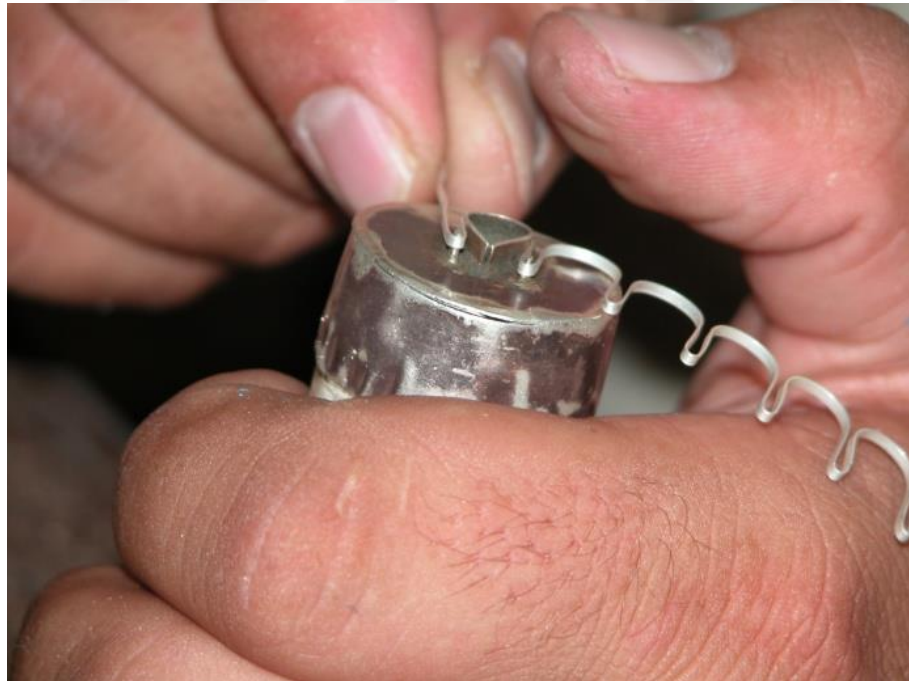
EK- 5. 14. Kalıp ile iskelet oluşturma
