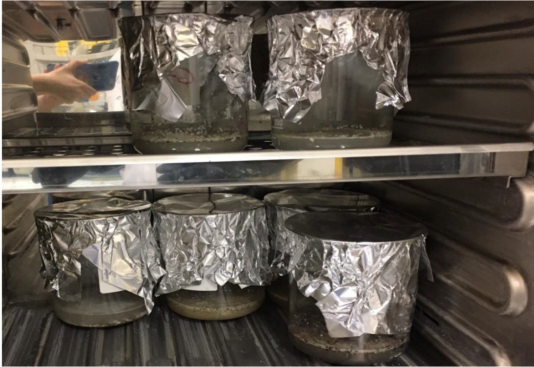
Şekil 3.32. Mikroplastik incelemek için H_2O_2 eklenen örneklerin etüvde bekletilmesi
