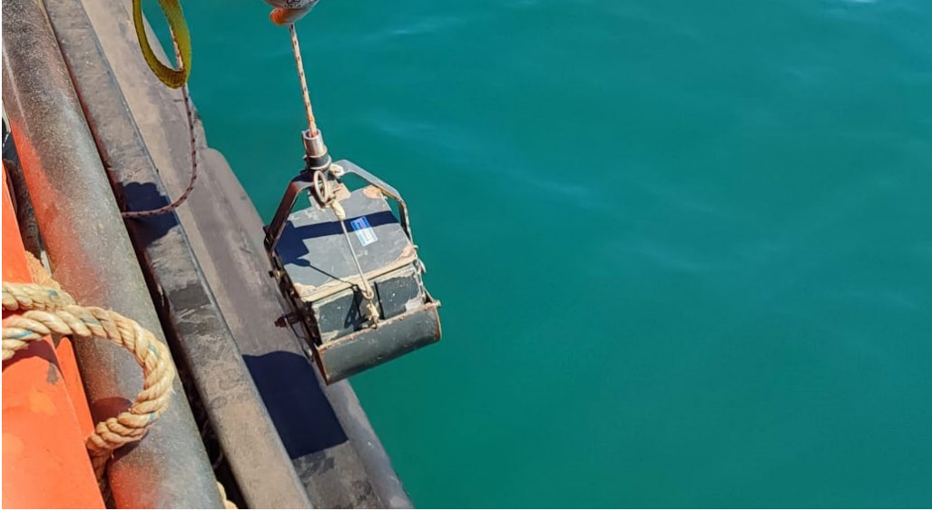
Şekil 3.26. Yüzey sediment örneği almada kullanılan Lenz Bottom Sampler tip sediment kepçesi (08.09.2022)
