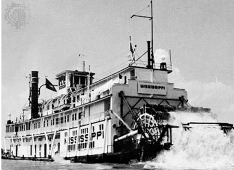
Şekil 1.11 Verimli olmalarına rağmen, hava ve su koşullarına karşı duyarlılıkları dolayısıyla çarkların yerini nihayetinde pervaneler almıştır. Ancak nehirler ve göller gibi iç sularda bir süre daha kullanılmaya devam edilmişlerdir [31].
